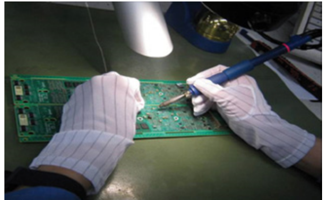
Abb. 1 Kolbenlöten mit Lötspitze, Lötendraht und Absaugung
