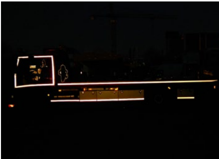
Abb. 10 Beleuchtung der Konturmarkierung mit einer Taschenlampe bei Nacht retroreflektierender Markierungen für schwere und lange Kraftfahrzeuge und ihre Anhänger vom 15. Juni 2015 entsprechen. Für die Anbringung gilt ECE-Regelung Nr. 48 vom 08.10.2016.
