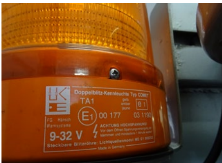
Abb. 6 Alle Warnleuchten bzw. Blinkleuchten müssen eine Bauartgenehmigung nach § 22 a StVZO haben (kenntlich gemacht durch ein Prüfzeichen)
