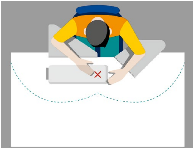
Abb. 11a Tischplatte mit Flachbettnähmaschine in Draufsicht mit Armauflagen und Greifraum (grüne Radien)
