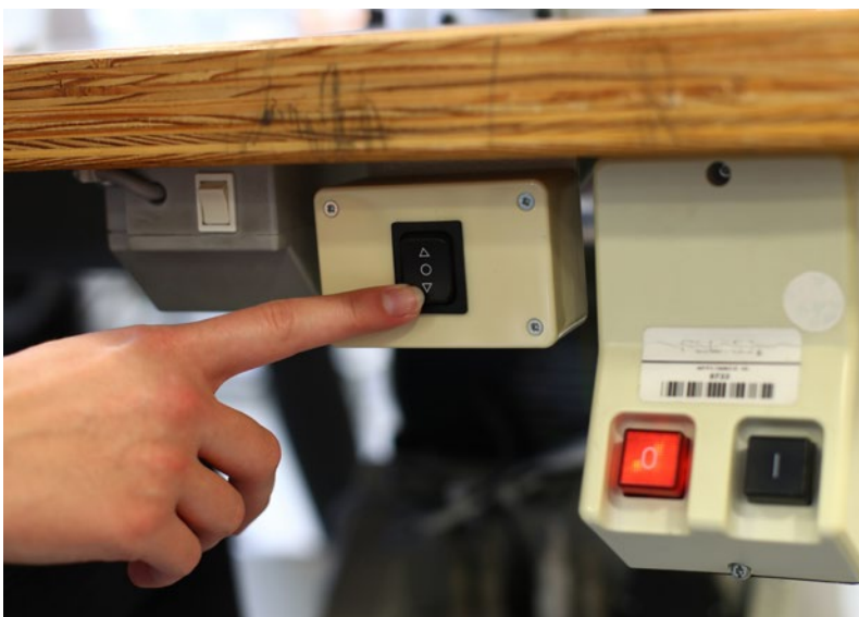
Abb. 2b Bedienelemente der elektromechanischen H ohenverstellung
