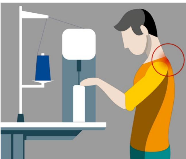
Abb. 10 a Arbeitshaltung an einer Säulennähmaschine: Belastung durch frei gehaltene Arme (Haltearbeit) mit der Folge häufiger Schulter-Nackenschmerzen
