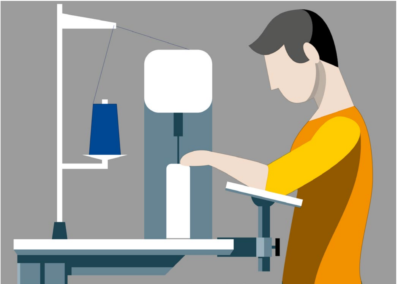
Abb. 13 a Säulennähmaschine mit Armauflagen vorne am Tisch, Schemazeichnung seitlich
