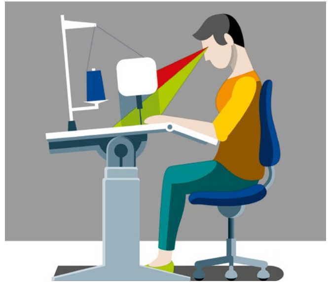
Abb. 4 b Verbesserte Einsehbarkeit durch geneigte Tischplatte
