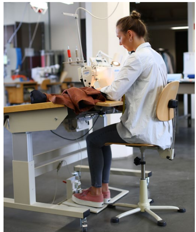
Abb. 8 Freier Beinraum: Alle st renden Maschinenelemente wurden nach au en verlegt.
