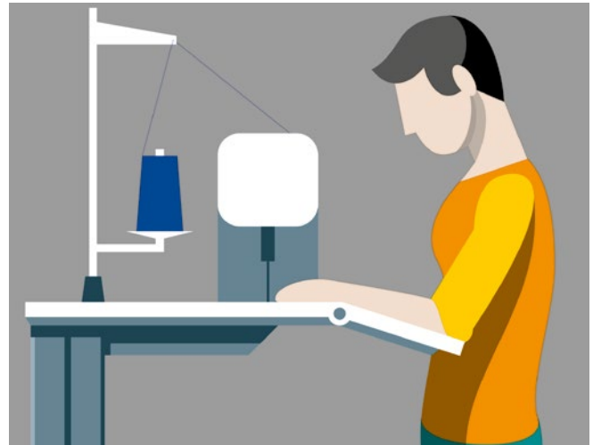
Abb. 11b Armauflagen für Flachbettnähmaschine – Seitenansicht
