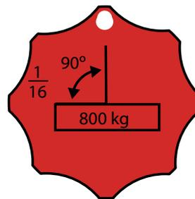
Abb. 31 Anhänger an 1-strängiger 16 mm-Kette > rot = Güteklasse 8
