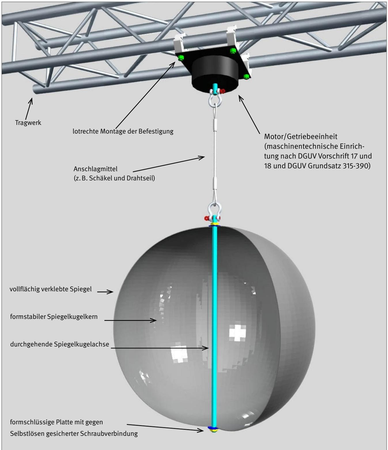
Abb. 45 Eigensicheres Spiegelkugel-System
