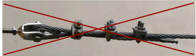
Abb. 15 Seilklemme nach DIN 1142 (alt) oder DIN EN 13411-5: 2009-02
