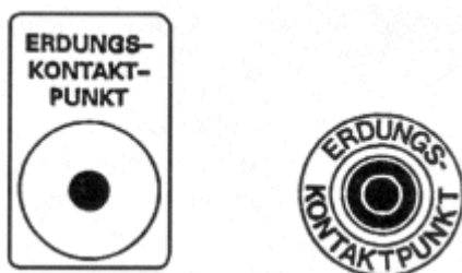
Abb. 4 Beispiele für Kennzeichnung des Erdungskontaktpunktes
