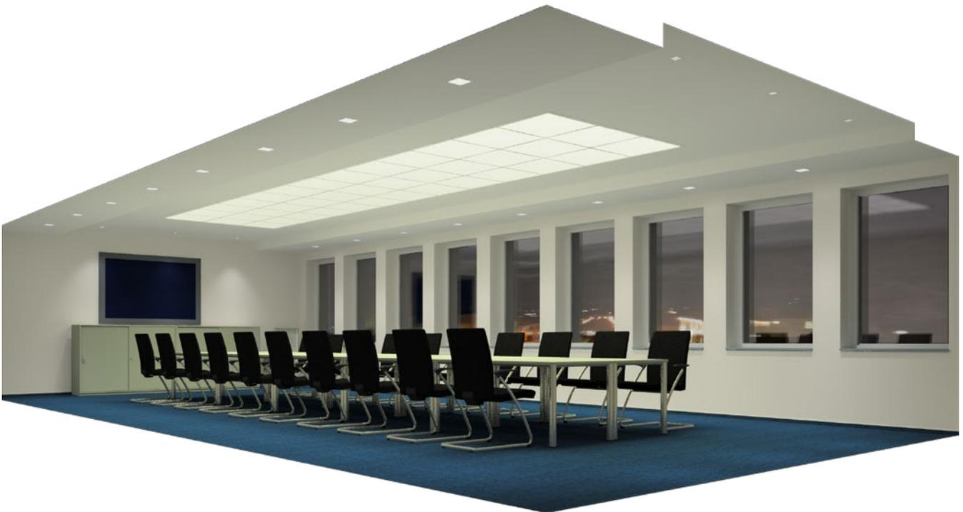
Direktstrahlende quadratische Deckeneinbau-Flächen leuchten bilden eine große Lichtdecke über dem Konferenztisch, die eine helle tageslichtähnliche Lichtatmosphäre erzeugen kann. Die breitstrahlende Lichtcharakteristik erzielt eine gleichmäßige Beleuchtung auf dem Konferenztisch und unterstützt die gute visuelle
