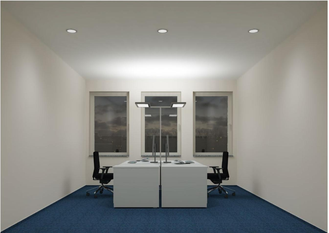
Für eine ausreichende Beleuchtung von Arbeitsplätzen mit Stehleuchten wird zumeist pro Arbeitsplatz eine Leuchte benötigt. In dem gezeigten Beispiel ist eine Stehleuchte mit zwei Leuchtenköpfen symmetrisch im Raum zwischen den Schreibtischen und vor der Fensterwand positioniert. Der Direktanteil der beiden Leuchtenköpfe sollte individuell steuer- bzw. schaltbar sein.
