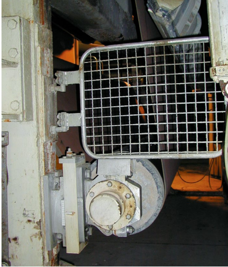
Abb. 12 Der seitliche Schutz des Filzaufbaus kann untergriffen werden. Weiterhin verwehrt er nicht den Zugang in die Maschine.
