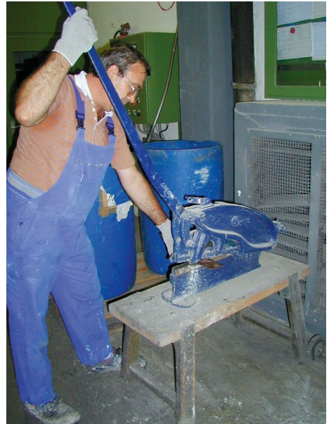
Abb. 30 Noch an der Papiermaschine werden die Klingen klein geschnitten und über die blaue Tonne im Hintergrund entsorgt. Lange Transportwege entfallen und das Verletzungsrisiko ist minimiert.
