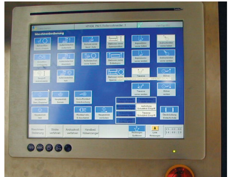
Abb. 38 Durch eine einzelne Betätigung darf keine gefährliche Situation herbeigeführt werden können. Die Gefahr einer unbeabsichtigten Berührung ist an Touch Screen Displays besonders groß.
