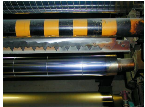
Abb. 37 Das Zackenmesser liegt in der Ruhestellung in einem Winkelprofil, das die Zacken verdeckt. Es besteht keine Verletzungsgefahr.
