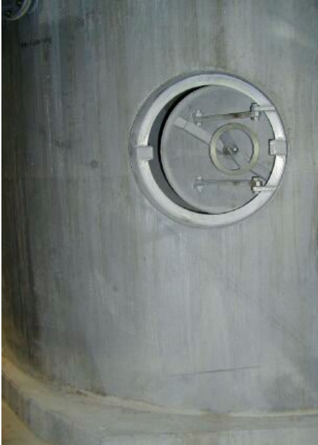
Abb. 35 Ein Mannloch an der tiefst möglichen Stelle der Bütte gewährleistet den Zugang ohne Leiter und dient außerdem der Belüftung. Es macht jedoch die Messung der Atemluft in der Bütte vor dem Einsteigen nicht überflüssig und ermöglicht das Retten lebloser Personen.
