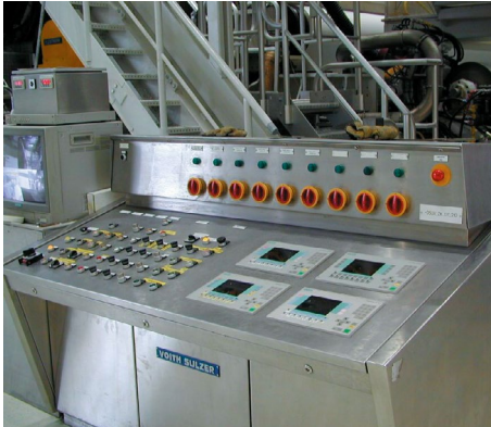
Abb. 39 Sogenannte „Sicherheitsschalter“ dürfen nur dann rot/gelb ausgeführt werden, wenn sie auf die Not-Halt-Einrichtung der Gesamtmaschine wirken.
