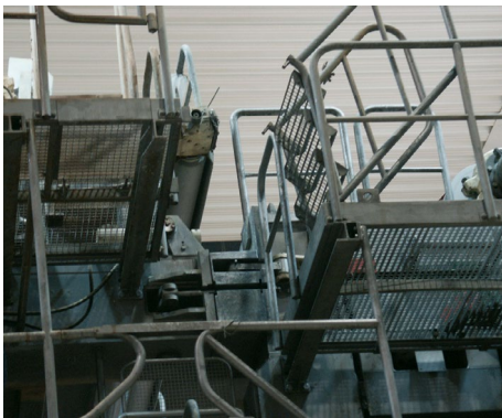
Abb. 14 Das Laufstegelement ist hochgeklappt und dient nach Arretierung als Absturzsicherung.
