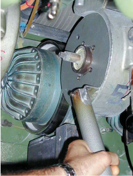
Abb. 31 Das Werkzeug wird auf das Kreismesser aufgesetzt. Die Innensechskantschrauben können gelöst werden. Das gelöste Messer wird durch Magnete im Werkzeug gehalten und lässt sich, ohne in die Hand genommen werden zu müssen, aus der Schneidpartie herausnehmen.
