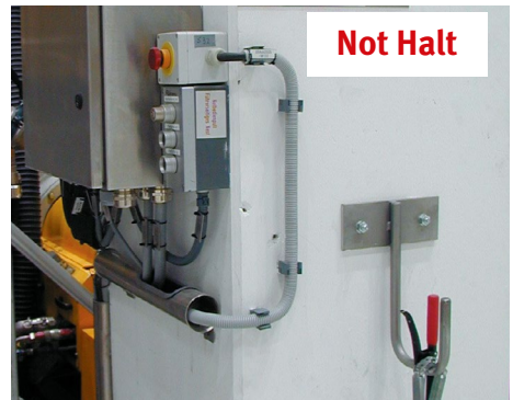
Abb. 26 Der rote Pilztaster ist durch seine Lage gegen unbeabsichtigtes Betätigen geschützt. Auf der Säule wird gut erkennbar auf ihn aufmerksam gemacht.
