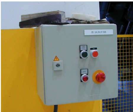
Abb. 25 Das Not-Halt-Befehlsgerät ist der rote gelb unterlegte Pilztaster. Die Verwendung des Schaltkastens als Ablage ist jedoch nicht bestimmungsgemäß.
