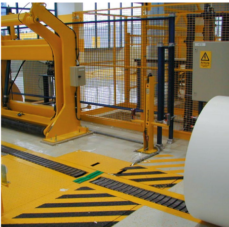
Abb. 7 Eine Papierrolle fährt durch eine „erkennende“ Lichtschranke in einen Gefahrenbereich, wo sie durch einen Rollenausstoßer vom Unterflur-Plattenband ausgestoßen wird.
