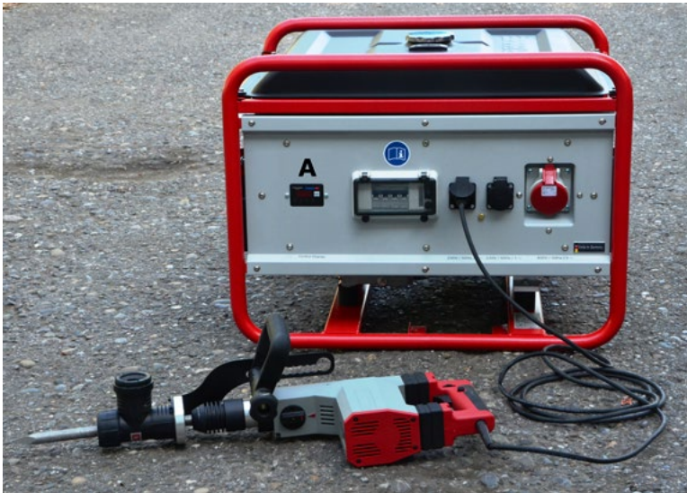
Abb. 20 Ein Betriebsmittel angeschlossen ohne weitere Schutzmaßnahme
