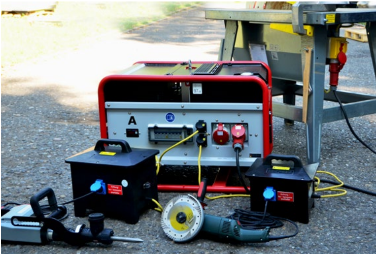
Abb. 27 Drei Betriebsmittel – Baustellenkreissäge direkt angeschlossen, Abbruchhammer und Winkelschleifer hinter jeweils einem Trenntransformator betrieben
