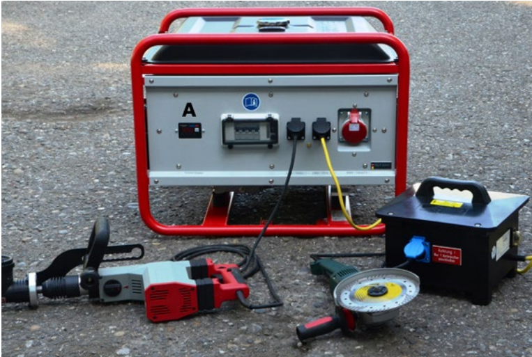
Abb. 26 Zwei Betriebsmittel – Abbruchhammer direkt angeschlossen, Winkelschleifer hinter zwischengeschaltetem Trenntransformator betrieben
