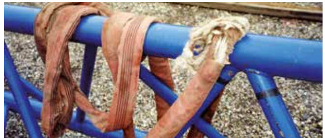
Bild 4-5: Starke Beschädigung der Ummantelung und der Einlage
