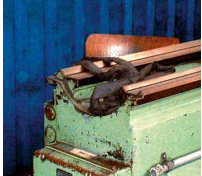
Bild 5-2: Ungünstige Lagerung von Anschlagmitteln, Beispiel 2
