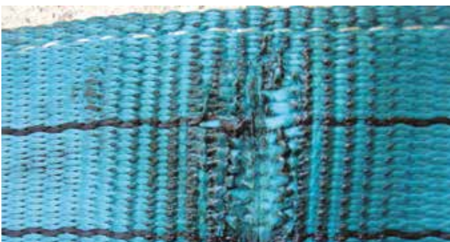
Bild 4-3: Durch Wärmeeinfluss beschädigte Oberfläche
