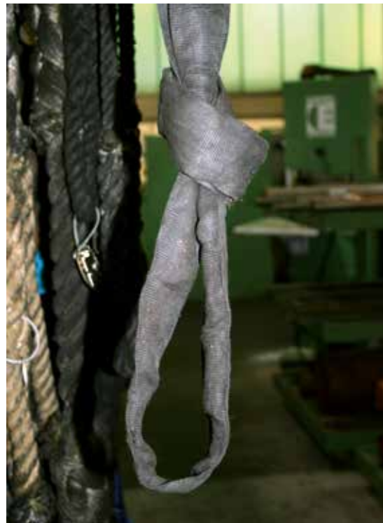
Bild 1-3: Unzulässiger Knoten in einer Rundschlinge
