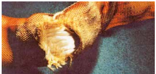
Bild 4-6: Beschädigung durch Hitzeeinwirkung; Ablegereife auch wegen Sichtbarkeit der Einlage erreicht
