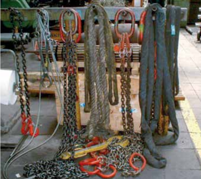
Bild 5-1: Ungünstige Lagerung von Anschlagmitteln, Beispiel 1
