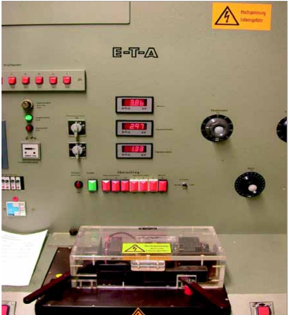
Bild 4: Prüfplatz mit zwangsläufigem Berührungsschutz, mechanische Verriegelung der Schutzhaube. Der Handhebel, der die Haube in Schutzstellung mechanisch verriegelt, ist mit Schaltkontakten belegt, die in den EIN- und AUS-Schaltvorgang integriert sind.
