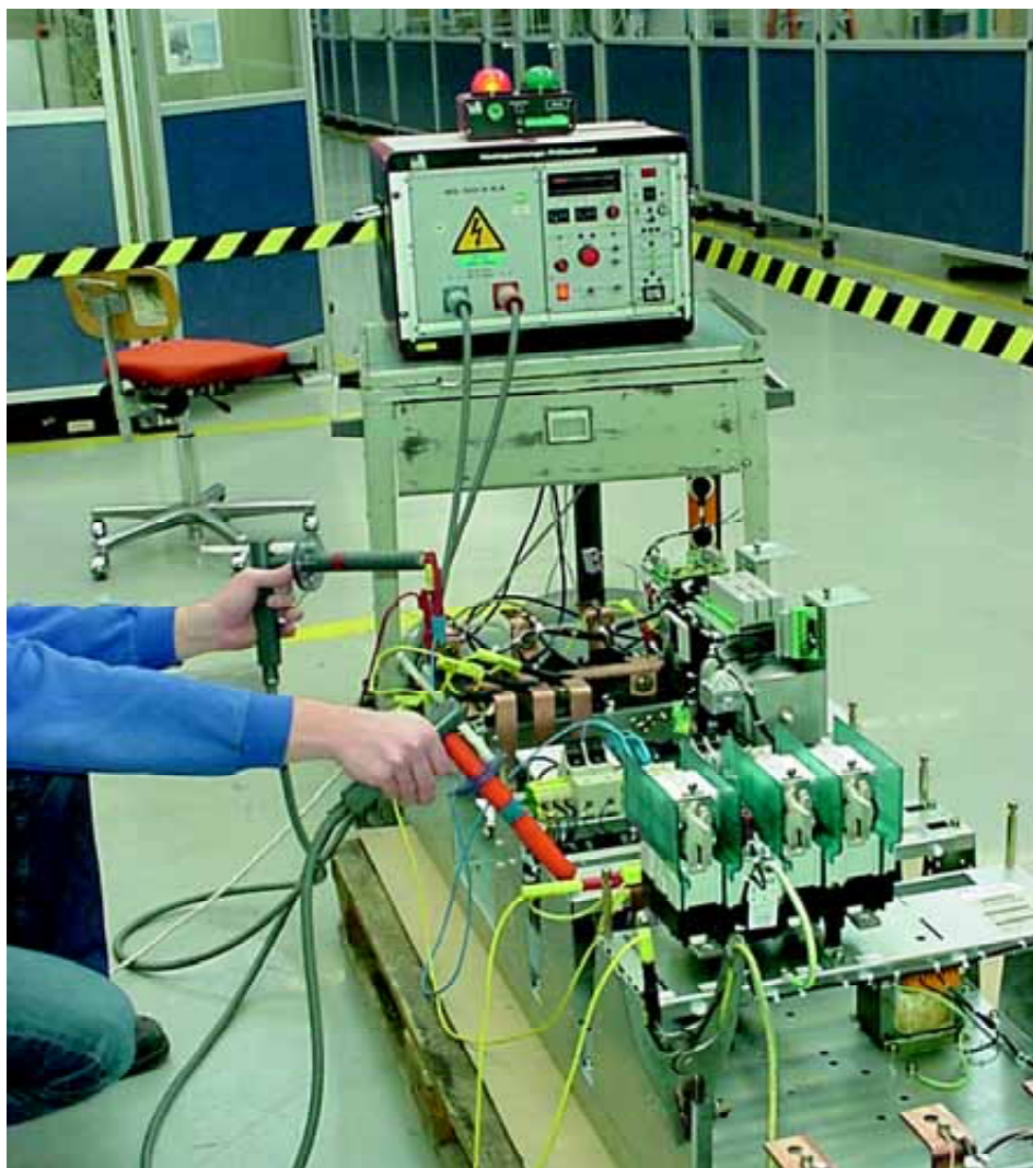
Bild 6: Prüfarbeiten unter Verwendung von Sicherheitsprüfspitzen
