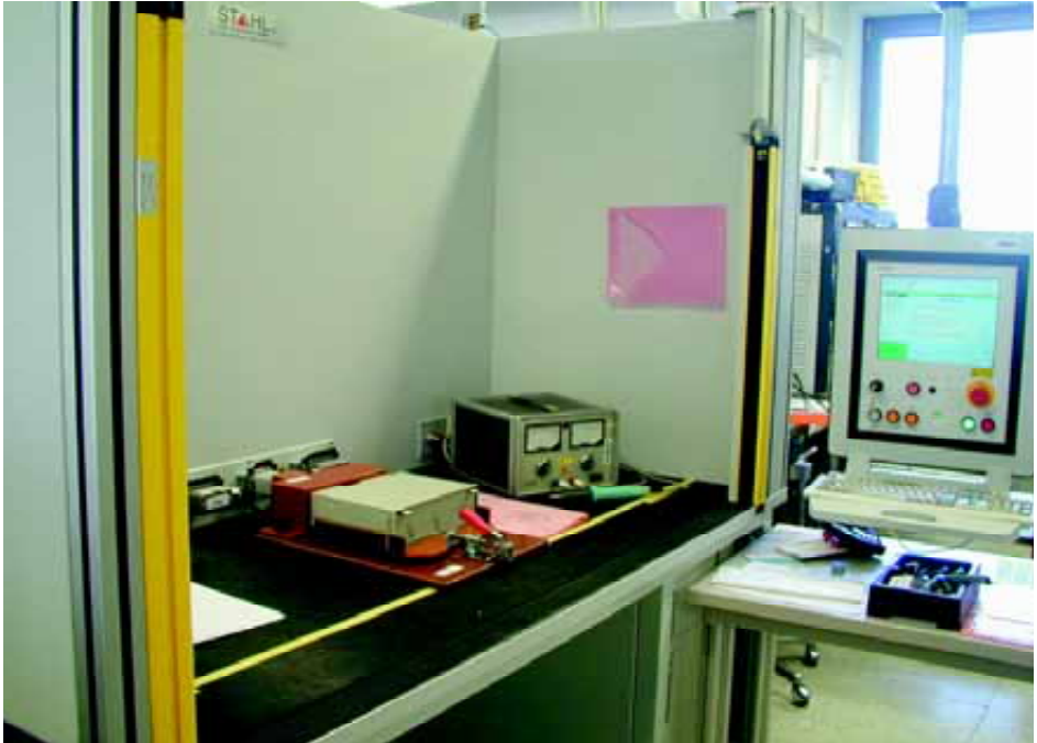
Bild 1: Prüfplatz mit zwangsläufigem Berührungsschutz durch Verwendung einer Sicherheitslichtschranke
