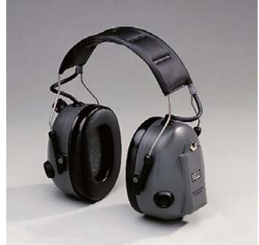
Abb. 7 Kapselgehörschützer mit pegelabhängiger Schalldämmung Laute Geräusche werden gedämmt. Leise Geräusche können elektronisch verstärkt werden, wobei die Sprachverständigung verbessert werden kann.
