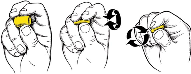
Der gerollte Gehörschutzstöpsel muss sofort in den Ohrkanal eingesetzt werden. Nur so kann man ihn mit geringem Durchmesser richtig positionieren.
