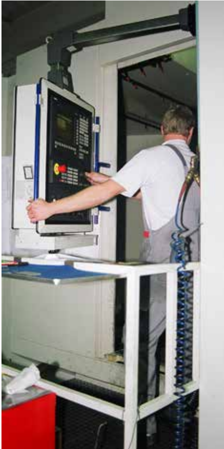
Abbildung 31: Ungünstige Anordnung des Bedienpultes
