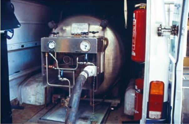
Mobile Rohrfrostgeräte zum offenen Rohrfrostverfahren wie, Speicherbehälter des Kältemittels (tiefkalter, verflüssigter Stickstoff), Sicherheitsarmaturen und Regeleinrichtungen sowie Kältemittelleitung und Absperrarmaturen.
