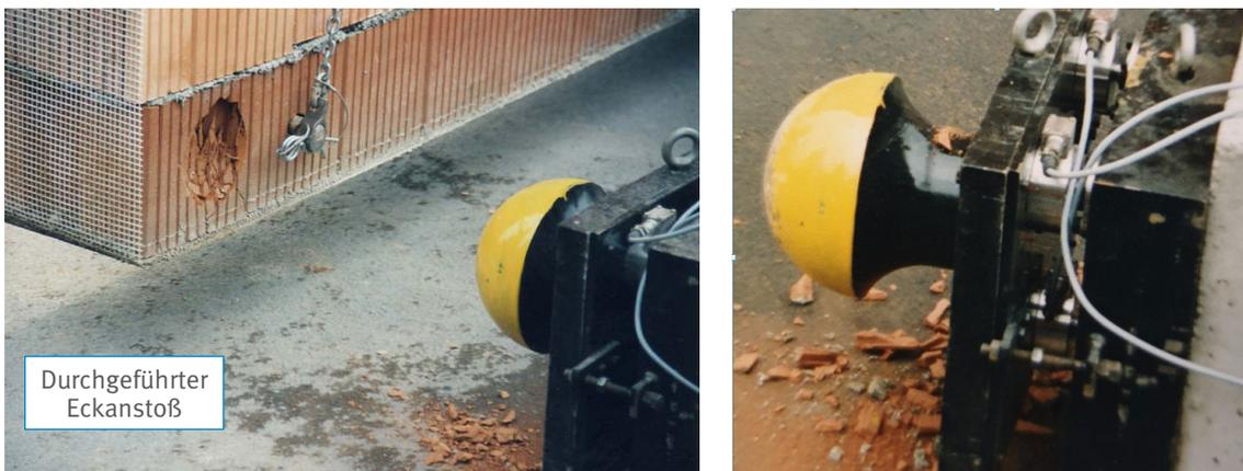
Abb. 26 Impulsmessung nach DGUV Grundsatz [3], Abs. 3.3.4, Versuch 1. Rechts: Anprallvorrichtung mit Kraftmessdose
