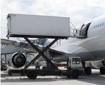
Abb. 6a Arbeiten mit Kontakt zum Luftfahrzeug
