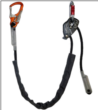
Abb. 36 Beispiel für ein Halteseil mit einem dreifach gesicherten Karabinerhaken an der Längeneinstellvorrichtung sowie einem automatisch zweifach gesicherten Karabiner am freien Ende.
