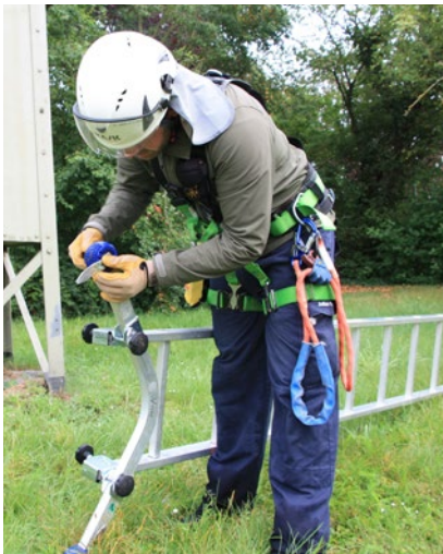
Abb. 76 Beispiel für eine Anlegeleiter, die mit einer Traverse einschließlich Erdspießen zur Verbesserung der Stand-sicherheit ausgerüstet ist.
