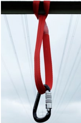
Abb. 57 Bandschleufe zur Schaffung eines Anschlagpunktes nach DIN EN 795. Im Ankerstich befestigte Anschlagmittel verlieren mit dieser Befestigungsweise einen erheblichen Teil ihrer Tragfähigkeit. Nähere Angaben sind der Gebrauchsanleitung des Herstellers zu entnehmen.
