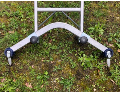
Abb. 154 Einsatz von Anlegeleitern mit justierbarer Fußtraverse und Erdspießern zum Niveaueausgleich (auch als Nachrüst-satz erhältlich).
