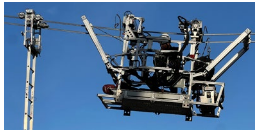
Abb. 139 Speziell zur Rettung von Personen mit einer horizontal verschiebbaren Bodenwanne ausgestattetes Leitungsfahrzeug.
