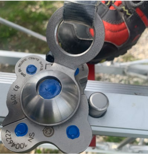
Abb. 107 Ausführung der Anschlagereinrichtung mit Zwischenanschlag, der über eine Fußraste entriegelt werden kann.
