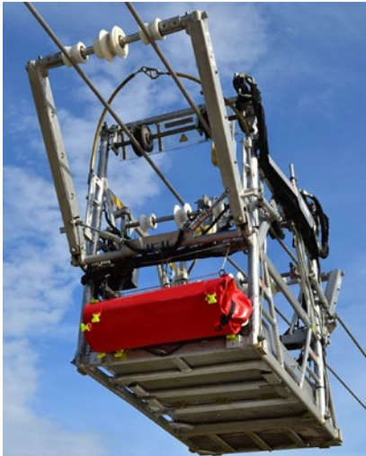
Abb. 136 Leitungsfahrzeug mit integriertem Seilsack, aus dem im Rettungsfall vom Retter funkgesteuert das Seil für den Befahrsitz abgeworfen werden kann.
