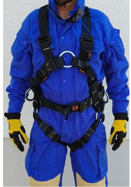
Abb. 32 Beispiel für einen Auffanggurt nach DIN EN 361 mit vorderer Auffangöse und zusätzlicher Auffangöse in Steigenschutzposition. Der Bauchgurt ist mit zwei seitlichen Halteösen ausgestattet.
