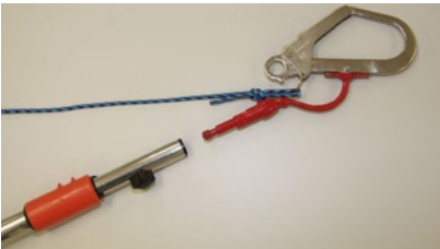
Abb. 66 Beispiel für eine zur Bedienung mittels Seilzug zugelassene Anschlagrichtung (EN 795 Typ B).
