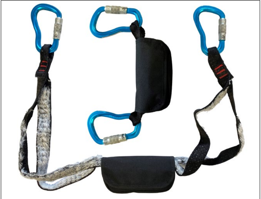
Abb. 43 Vergleich eines Bandfalldämpfers nach DIN EN 355 im neuwertigen und beanspruchten Zustand.
