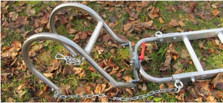
Abb. 115 Abspannleiter mit verstellbarem Aufhängekopf, der eine Ausrichtung der Leiter an Abspannmasten zu Leiterseilen/-bündeln ermöglicht.
