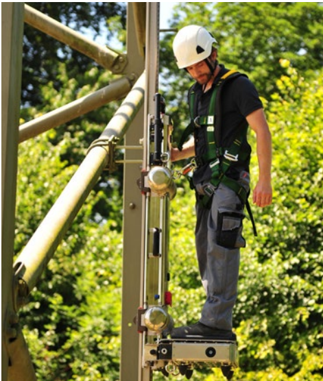
Abb. 16 Beispiel für den Einsatz einer elektromotorisch betriebenen Befahreinrichtung an einer Steigschiene. Der Auffanggurt ist mit dem Anschlagpunkt der Befahreinrichtung verbunden.
