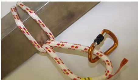
Abb. 35 Seilschleife zur Schaffung eines Anschlagpunktes.
