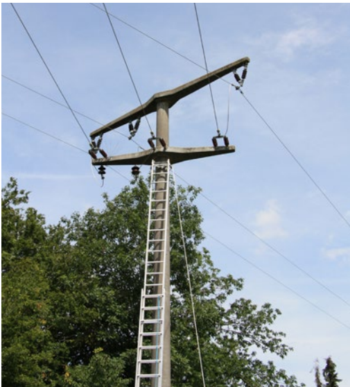
Abb. 91 Beispiel für eine mehrteilige Auszugsleiter mit Seilzug und Leiterkopfsicherung.
