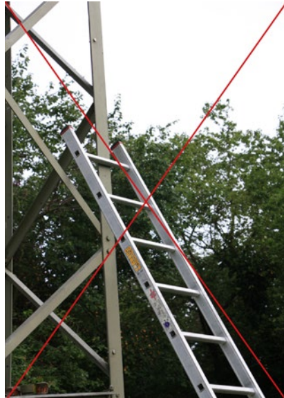
Abb. 79 Beispiel für eine nicht stand-sichere Aufstellung einer Anlegeleiter.
