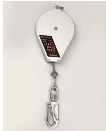
Abb. 18 Auffangsysteme mit Höhensicherungsgeräten (DIN EN 360) sind an Freileitungen nur unter bestimmten Bedingungen einsetzbar (für Arbeiten an Isolatoren, bei denen die Höhensicherungsgeräte senkrecht oberhalb des Arbeitsbereiches, beispielsweise an einer Traverse, angebracht werden können).
