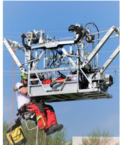
Abb. 137 Beispiel für einen kraftbetriebenen Befahrsitz, mit dem der Retter am vertikalen Seil zum Leitungsfahrzeug hinauf fahren kann.
