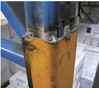
Abb. 11 Unfachmännisch geschweißte Stütze
