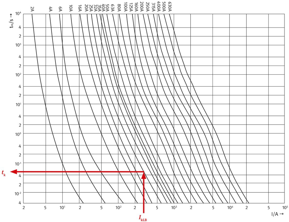
Abb. 4-3 Beispiel zur Ermittlung der Abschaltzeit der Überstromschutzeinrichtung
