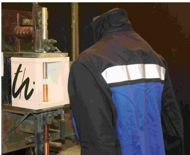
Abb. A 2-1 Prüfaufbau Box-Test Verfahren
