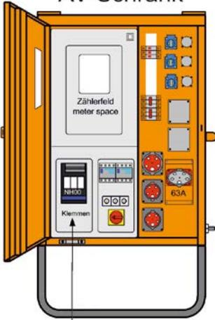
Abb. 3 Versorgung einer kleineren Baustelle mit nur einem Anschlussverteiler-Schrank
