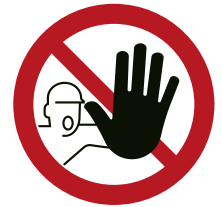
Abb. 5 Kennzeichnung D-P006 „Zutritt für Unbefugte Verboten“
