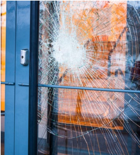
Abb. 2 Verbund-Sicherheitsglas schützt vor Verletzungen durch Binden der Glasstücke bei Bruch
