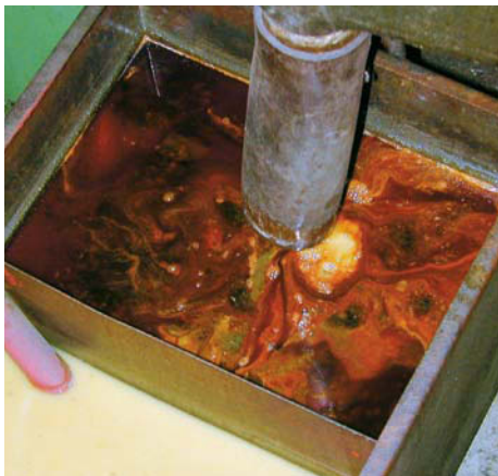
Bild 54 Emulsion im KSS-Behälter; Standzeit sechs Monate
