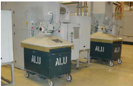
Bild 50 Abgedeckte und gekennzeichnete Alu-Spänebehälter
