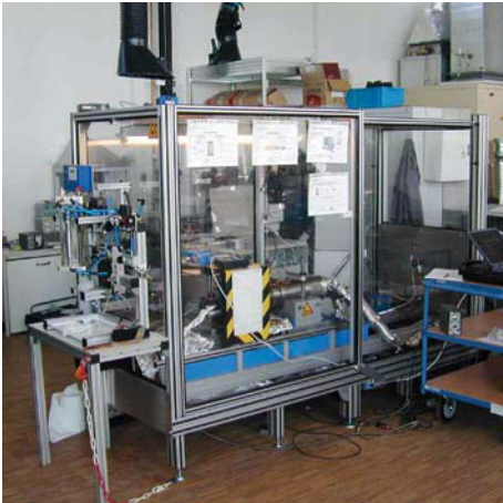
Bild 44 Prüfstand zur Bestimmung der Emissionen im Innenraum
