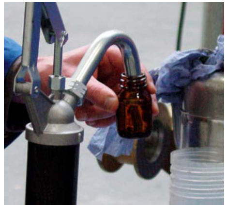
Bild 3 Schmierstoffbedarf einer Arbeitsschicht bei Minimalmengenschmierung
