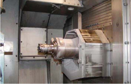
Bild 23 Nutzung der Schwerkraft zur Späneabfuhr, steile Bleche
