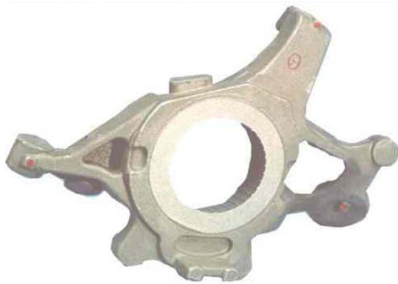
Bild 56 Hinterachs-Radträger der Mercedes-Baureihen „E und SL“
