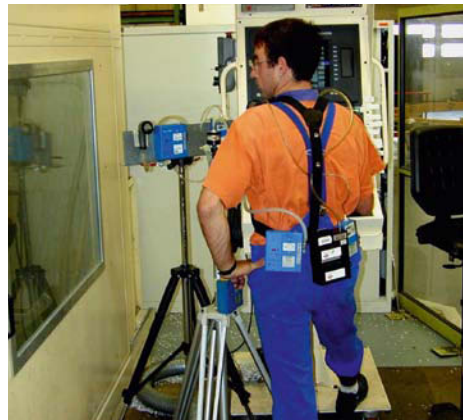
Bild 41 Expositionsmessungen stationär sowie personengetragen am Bedienpult
