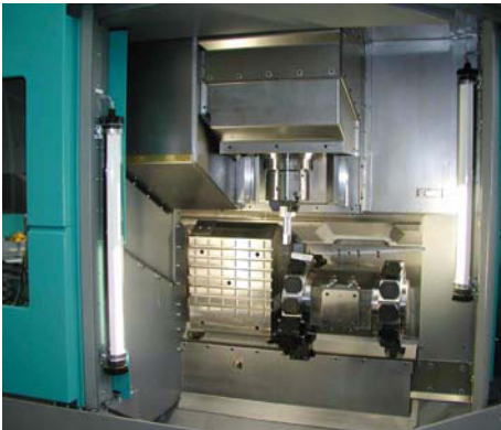
Bild 21 Innenansicht einer MMS-Werkzeugmaschine
