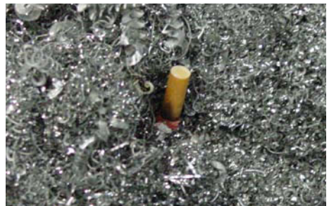
Bild 51 Brennender Zigarettenrest im Spänebehälter
