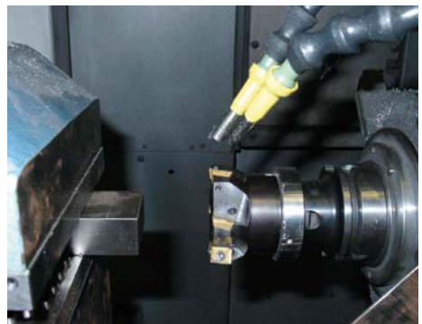
Bild 5 Äußere Zufuhr über Düsen
