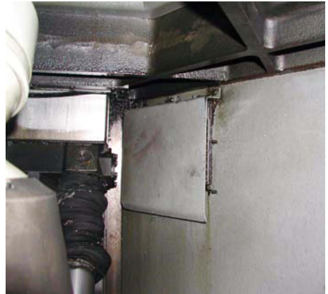
Bild 30 Prallblech über Absaugstelle
