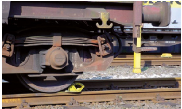
Abb. 7-17: Hemmschuhe sichern abgestellte Waggons gegen Wegrollen.
