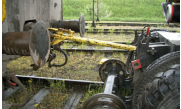
Abb. 7-16: Vom Bahnbetreiber zugelassene Kuppelstange.
