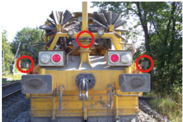
Abb. 9-6: Ultraschallsensoren an einer Schotterplaniermaschine: die Sensoren geben dem Bediener ein akustisches Signal bzw. stoppen die Maschine, sobald eine Person den Nahbereich vor der Maschine betritt.
