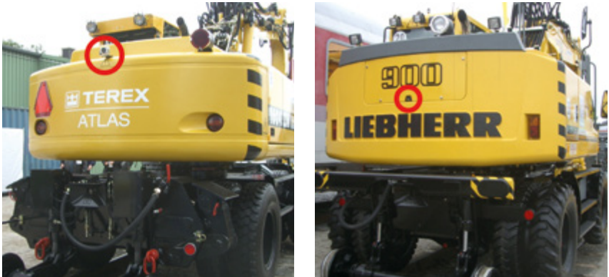
Abb. 7-7: Die Rückraumüberwachung ist für Zweiwegebagger Standard (rechts: Kamera in den Oberwagen integriert).
