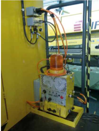
Abb. 8-6: Funkempfänger, der vom Sicherungsunternehmen zur Ansteuerung der Maschinenwarnanlage auf die Gleisbaumaschine gestellt wird.
