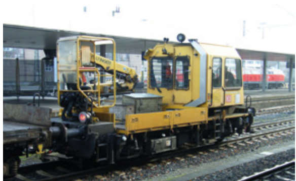
Abb. 9-7: Gleisarbeitsfahrzeug: unter eingeschalteter Oberleitung dürfen Aufbauten auf der Ladefläche nicht bestiegen werden, neben Betriebsgleisen darf der Anbaukran nur mit Ausschwenkbegrenzung betrieben werden.
