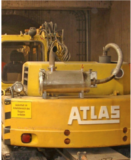
Abb. 11-3: Zweiwegebagger im Tunnel mit Rußpartikelfilter.
