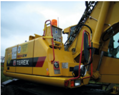
Abb. 7-21: Mobile funkangesteuerte Signalgeber auf Zweiwegebaggern (Testeinsatz für akustische Messungen).
