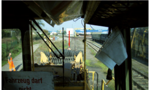
Abb. 9-5: Sichteinschränkung im rückwärtigen Bereich einer Schotterplaniermaschine. Die gerade erkennbare Person in gebückter Haltung befindet sich 15 m vor der Pufferbohle.
