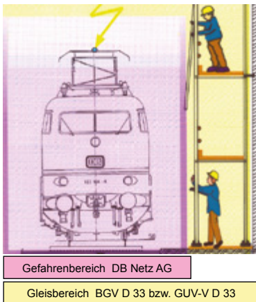
Abb. 1-1: Beispiel zum Gleisbereich: Beim Hantieren mit Gerüstrohren neben dem Gleis besteht die Gefahr, in den durch Druck- und Sogeinwirkungen gefährdeten Bereich hineinzuweichen oder den Schutzabstand zu unter Spannung stehenden Teilen der Fahrleitungsanlage zu unterschreiten. Der Gleisbereich umfasst in diesem Fall auch die Arbeitsplätze der Gerüstbauer. Bei der DB schließt der Gleisbereich den Gefahrenbereich ein (vgl. Anhang 3).
