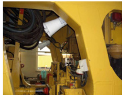
Abb. 2-14: Funkangesteuerte Warnsysteme auf Gleisbaumaschinen (links: Hersteller Schweizer Electronic AG, rechts: Hersteller Zöllner Signal GmbH).
