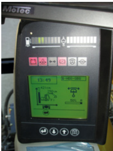
Abb. 7-22: Display für Hub- und Schwenkbegrenzung am Zweiwegebagger.
