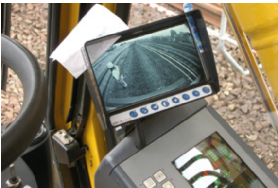
Abb. 7-6: Sicht durch die Kamera am Oberwagenheck auf den Beschäftigten in gleicher Position wie Abb. 7-4.
