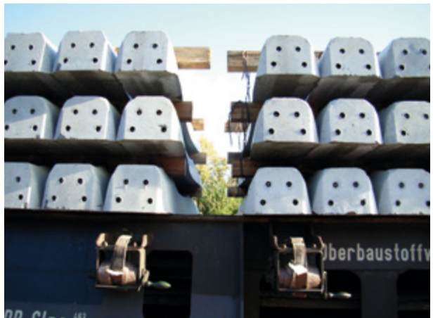
Abb. 8-10: Bei Aufenthalt auf Waggonen oder Maschinen muss der Schutzabstand zur Oberleitung eingehalten werden. Bei einer Oberleitungshöhe von 4,95 m darf die Standhöhe über Schienenoberkante max. 1,45 m betragen. Arbeiten mit aufragenden Gegenständen sind nicht zulässig.
