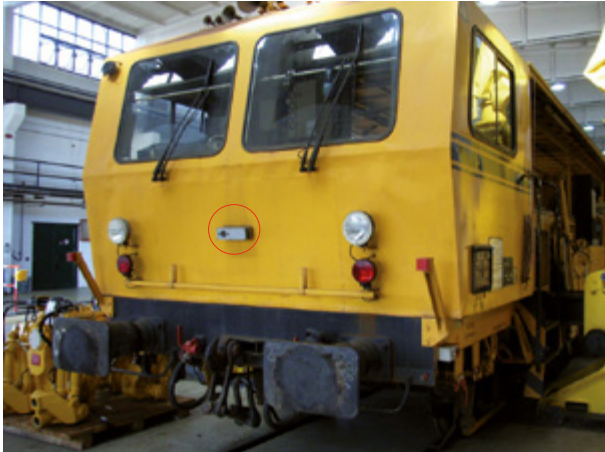
Abb. 9-4 : Ausrüstung einer Stopf- maschine mit Kamera- Monitor-Systemen
