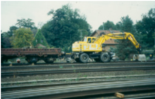
Abb. 7-14: Bewegen von Waggonen mit dem Zweiwegebagger.
