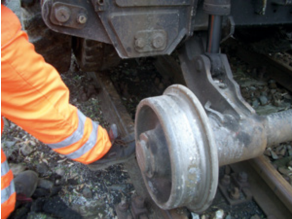
Abb. 7-8: Quetschgefahr zwischen Unterwagen und Schienenachse.
