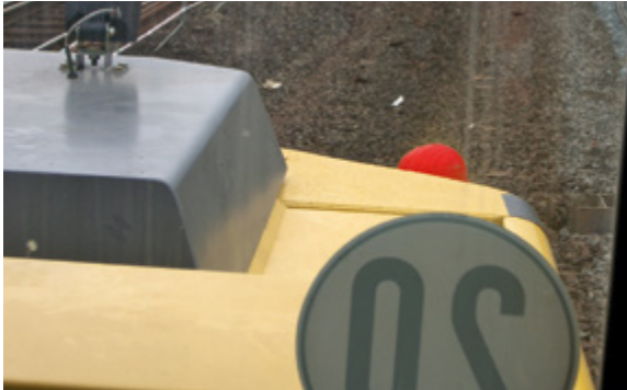
Abb. 7-4: Sicht des Baggerführers aus dem rückseitigen Kabinenfenster auf einen Beschäftigten, der etwa 0,5m hinter dem Bagger steht: nur ein Teil des Schutzhelms ist sichtbar.
