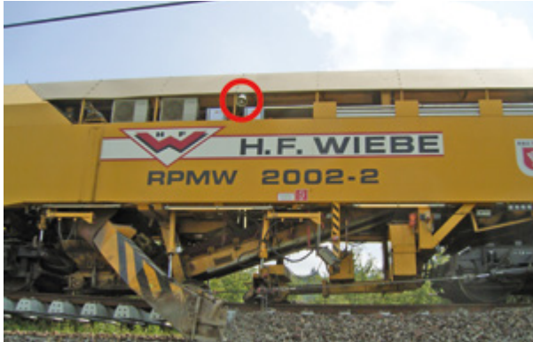
Abb. 8-3: Maschineneigenes funkgesteuertes automatisches Warn- system auf einer Pla- numsverbesserungs- maschine.
