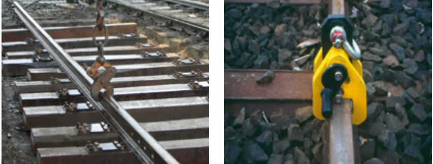
Abb. 7-11: Schienenhebezeuge ohne Öffnungssperre (links, nicht zulässig) und mit Öffnungssperre (rechts).
