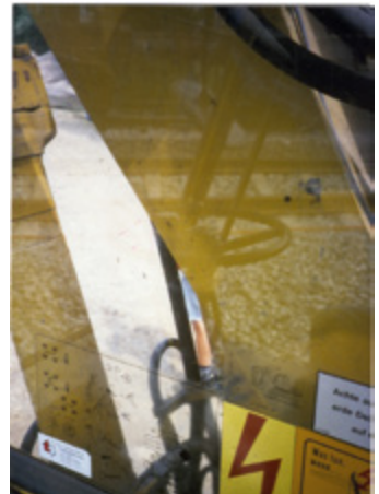
Abb. 7-2: Sichtbehinderung nach vorne rechts durch den Ausleger des Zweibegebaggers.
