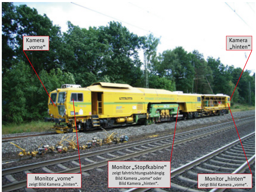
Abb. 9-4 : Ausrüstung einer Stopf- maschine mit Kamera- Monitor-Systemen
