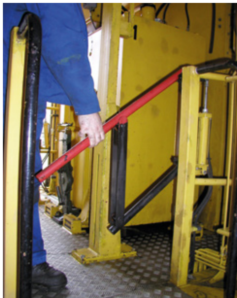
Abb. 9-2: Klappbare feste Verriegelung an einer Stopfmaschine, um unbeabsichtigtes Verlassen der Maschine zum Betriebsgleis auszuschließen.
