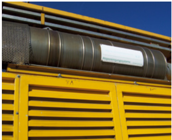
Abb. 11-4: Rußpartikelfilter auf einer Stofmaschine.
