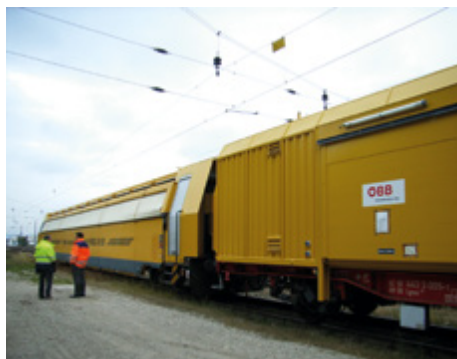
Abb. 9-8: Mobile Instandhaltungseinheit mit geschütztem Arbeitsraum (rechts) und integrier-tem Sozialraum (Hersteller: ROBEL Bahnbaumaschinen GmbH).
