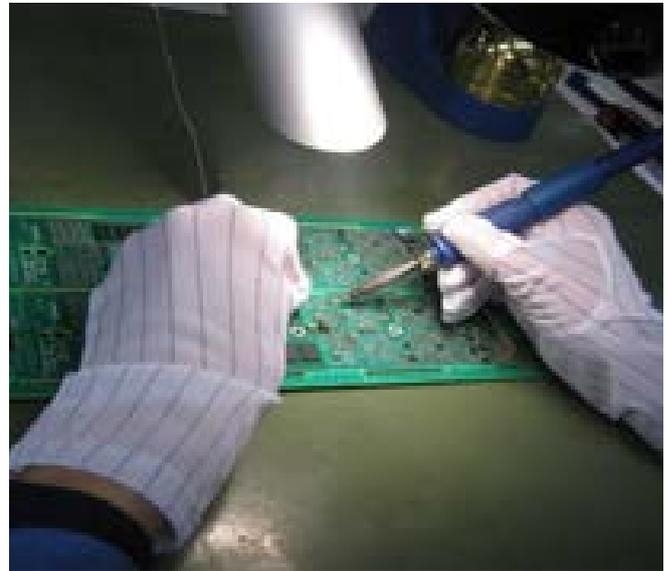
Abbildung 1 Bleifreies Kolbenlöten mit Lötspitze, Lötendraht und Absaugung
