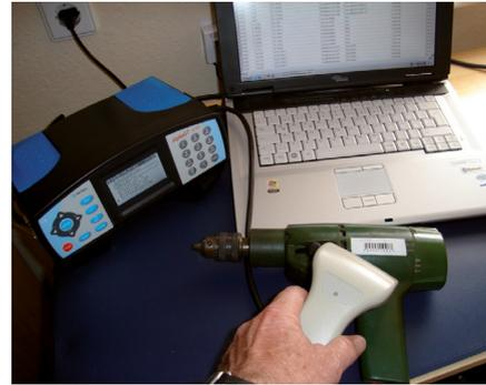
**Bild 3:** Rechnergestützter Prüfplatz mit Barcode-Scanner
