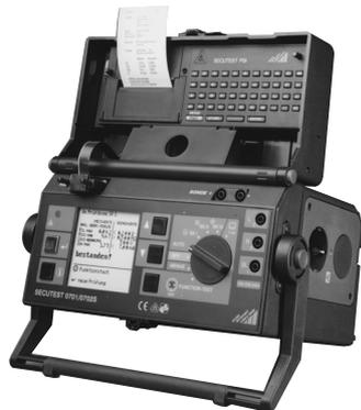
**Bild 2:** Universalprüfgerät mit Speicher- und Druckfunktion
