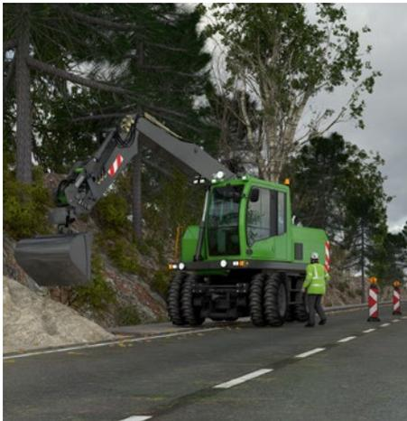
Abb. 5 Erkennbarkeit einer Person mit Warnkleidung vor Arbeitsgerät
