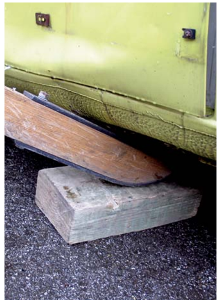
Der Hebebaum im Einsatz als einseitiger, ungleicharmiger Hebel
