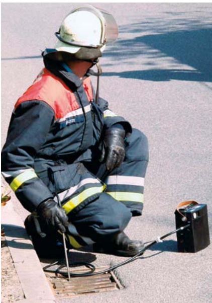
Messgeräte-Einsatz zur Feststellung von Explosionsgefahren
