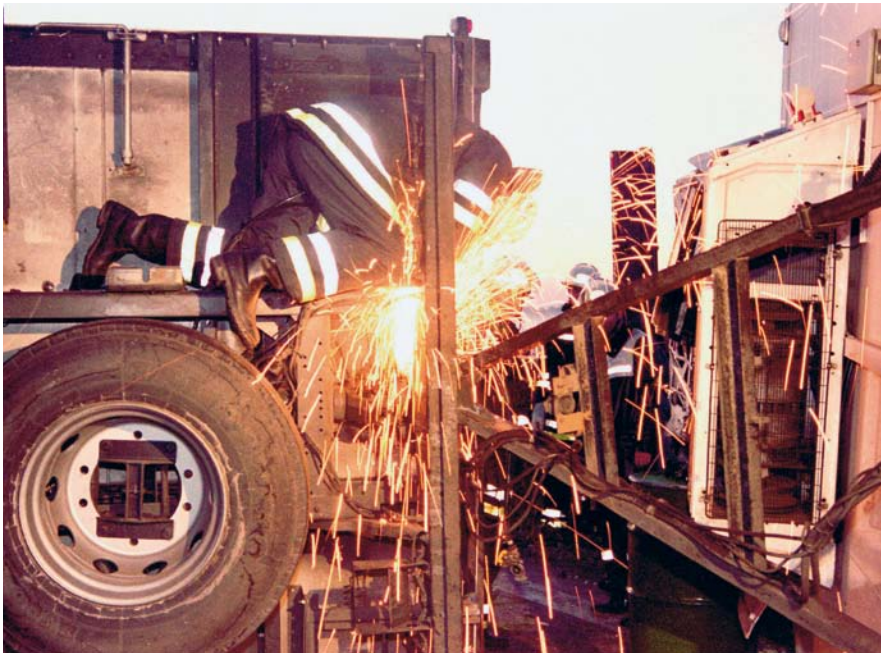
Brennschneiden unter erschwerten Bedingungen nach einem LKW-Unfall
