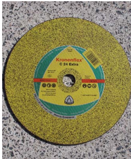
Trennschleifscheibe für erhöhte Umfangsgeschwindigkeit mit rotem Farbstreifen
