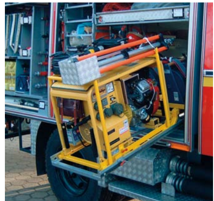
Schräglagerung des Geräteschlittens
