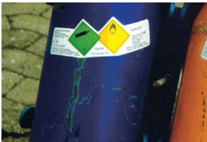
Gefahrzettel an einer Sauerstoffflasche (Transportgefäß)
