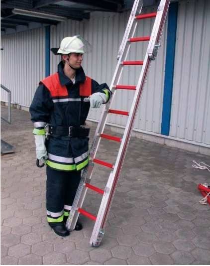
So kann der richtige Anstellwinkel überprüft werden.
