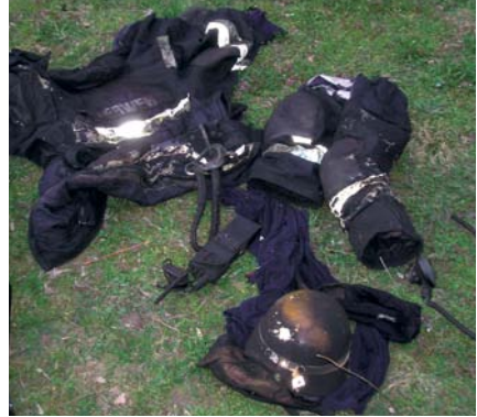
Das Ende eines Innenangriffs – die persönliche Schutzausrüstung des Angriffstrupps ...
