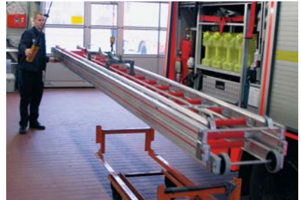
Hebezeugeinsatz und Transportwagen zum sicheren und körpergerechten Transport der Schiebeler
