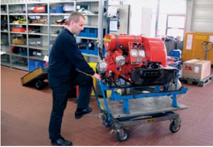
Transportwagen für Tragkraftspritzen mit mechanischer Höhenverstellung
