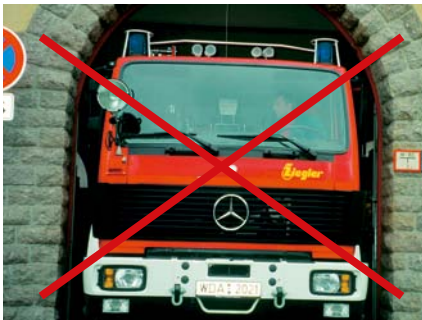
Gefahr! Diese Tordurchfahrt war allenfalls für bespannte Kraftspritzen ausreichend breit ...
