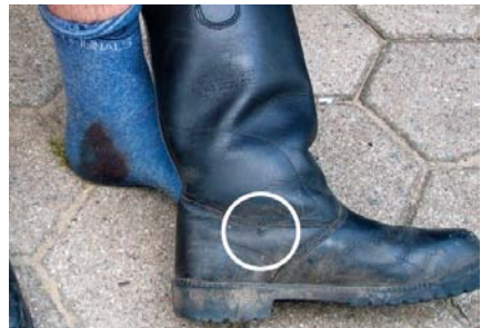
In den Schaftstiefel ist seitlich ein spitzer Gegenstand eingedrungen und hat die Fußverletzung verursacht.
