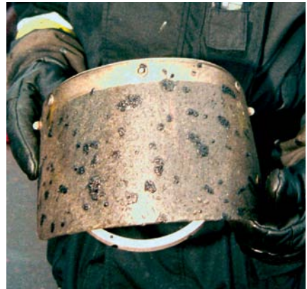
Gesichtsschutz nach starker Wärme-Einwirkung
