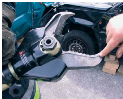
Sichtprüfung der Schneidmesser
