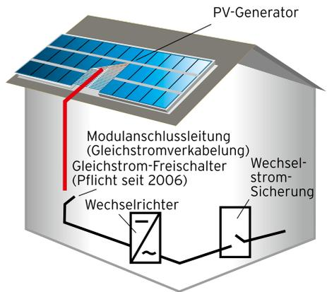
Abb. 23 PV-Anlage (Schematisch)
