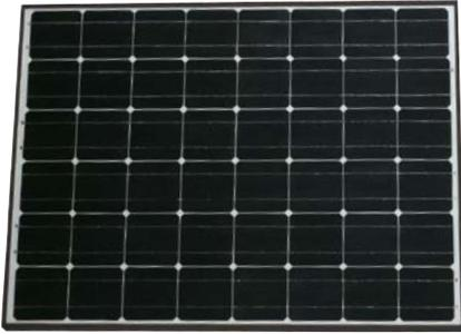
**Abb. 15** Module besitzen auf der Vorderseite eine Glasabdeckung. Diese schützt vor mechanischen Einflüssen und Witterung. Darunter sind die stromerzeugenden Zellen und deren Verbindungskontakte zwischen zwei dünnen Folien verpackt. Dadurch wird die elektrische Isolation gewährleistet.
