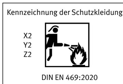
Abb. 36 Kennzeichnung Feuerschutzkleidung 05a
