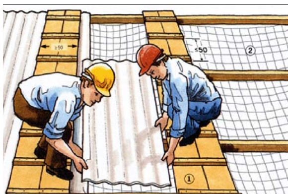
Abb. 6.2.1.1: Mindestanforderung an die verwendeten Bohlen (1): Dicke \geq 3 cm und Verkehrswegbreite \geq 50 cm. Im Bildbeispiel ist die Absturzsicherung durch ein Schutznetz gegeben (2).
