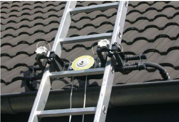
Abb. 4.3.4: Anlegeleiter als Zugangsweg zur Dachfläche: Eine justierbare Quertraverse ermöglicht ein unmittelbares Auflegen der Leiter auf die Dachfläche ohne Belastung der Regenrinne. Eine Sicherung gegen seitliches Verschieben ist gegeben.
