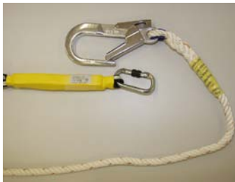
Abb. 7.4.3: Verbindungsmittel Verbindungsmittel nach EN 354 verbinden den Auffanggurt mit einem Anschlagpunkt oder mit einer beweglichen Führung. Der Einsatz ist nur in Verbindung mit einem Fall dämpfenden Element zulässig (siehe auch Tabelle Abb. 7.4.1). Verbindungsmittel müssen geeignete Endverbindungen haben und dürfen nicht länger als 2 m sein. Sie dürfen nicht geknotet werden (Knoten verringern die Tragfähigkeit erheblich).
