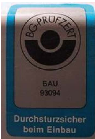
Abb. 7.3.2: Bitte beachten Sie, dass Lichtkuppeln mit der nebenstehenden Kennzeichnung nur für den Zeitraum des Einbaus durchsturz sicher sind. Aufgrund von Umwelt- und betrieblichen Einflüssen kann die Durchsturzsicherheit nicht auf Dauer gewährleistet sein.
