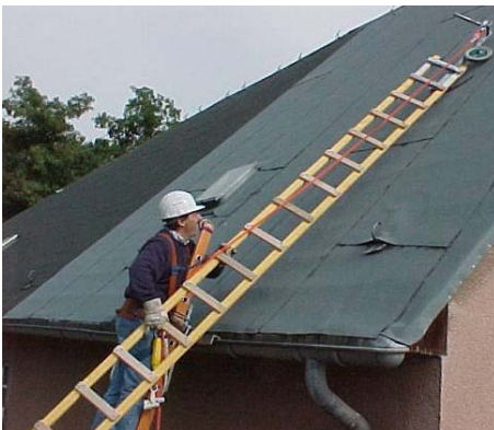
Abb. 6.2.2.4: Dachdeckerauflegeleiter mit Zusatzeinrichtung zum Einhängen in einen Dachständer. Zur besseren Handhabung verfügt die Leiter über eine Laufrolle. Die Zusatzeinrichtung beinhaltet auch einen Anschlagpunkt zur Befestigung der PSAgA.
