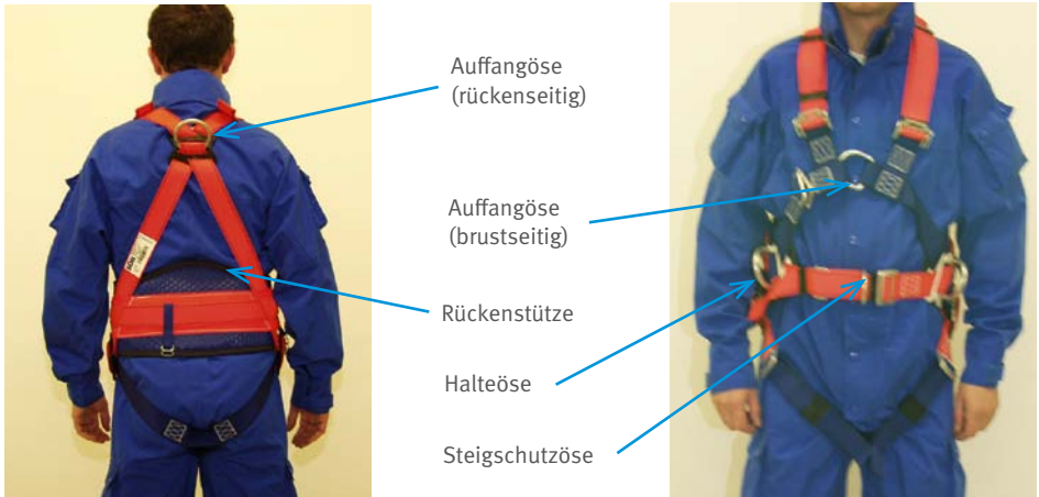
Abb. 7.4.2: Beispiel für einen Auffanggurt nach EN 361: Der abgebildete Gurt bietet jeweils eine Auffangöse auf der Rücken- und Brustseite sowie eine Steigschutzöse am Bauchgurt. Zusätzlich verfügt der Gurt über eine Rückenstütze sowie zwei seitliche Halteösen am Bauchgurt. Die Halteösen sind ausschließlich zur Positionierung der Person am Arbeitsplatz mit einem Halteseil oder als Bestandteile eines Rückhaltesystems, welches die Annäherung an eine Absturzkante verhindert, zu verwenden. Voraussetzung für eine optimale Funktion von Auffanggurten ist deren individuelle Anpassung an den Benutzer. Hierzu bieten die Gurte zahlreiche Einstellmöglichkeiten.
