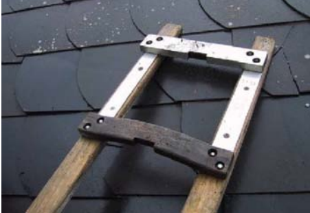
Abb. 6.2.2.2: Dachdeckerauflegeleiter mit verstärkten Sprossen. Zur bestimmungsgemäßen Verwendung der Leiter ist die Benutzungsanleitung des Herstellers zu beachten.
