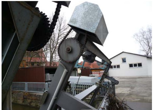
Abb. 6.2.1.2.8: Beispiel für eine Verkleidung eines Zahnantriebes einer seilgetriebenen RRM. Der untere Teil der Verkleidung ist zur Demonstration der Gefahrstelle abgenommen.
