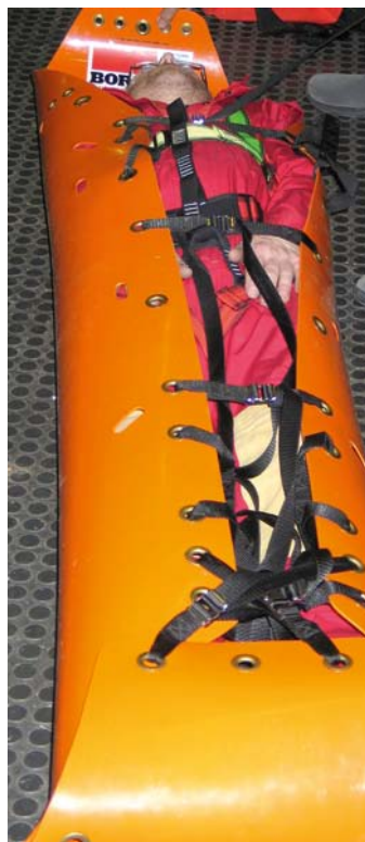
Abb. 9.1.6: Beispiel für eine Rettungsschale, die ein Bergen von Personen durch enge Einsteigöffnungen ermöglicht.
