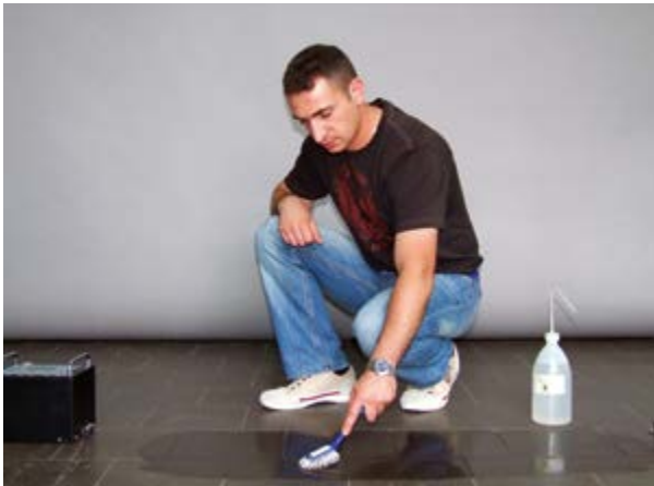
Abb. 5 Verteilen des Gleitmittels auf dem Boden
