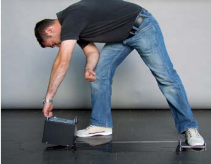
Abb. 11 Vermeidung von Stick-Slip durch gleitendes Aufset- zen des Messgeräts
