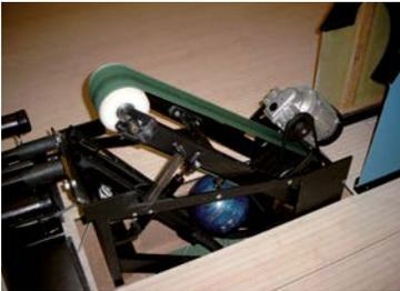
Abb. 33 Einzugsstelle zwischen Flachriemen und Umlenkrolle
