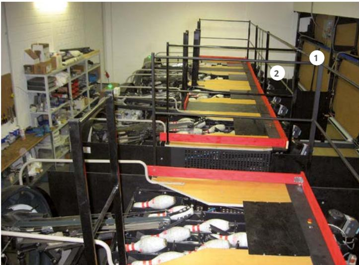
Abb. 32 Lauf- und Arbeitsbereich oberhalb der Stellmaschinen mit Absturz-sicherung (Handlauf und Knieleiste)
