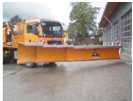
Abb. 9 Winterdienstfahrzeug mit doppelteleskopierbarem Vorbaupflug
