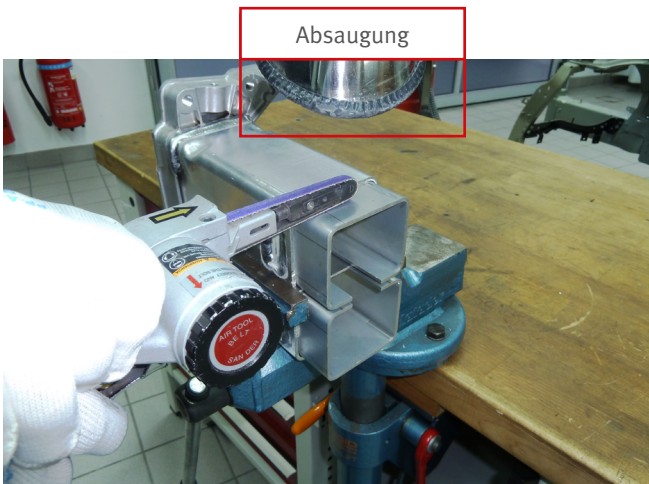
Abb. 3 Trockenbearbeitung mit Schleifband
