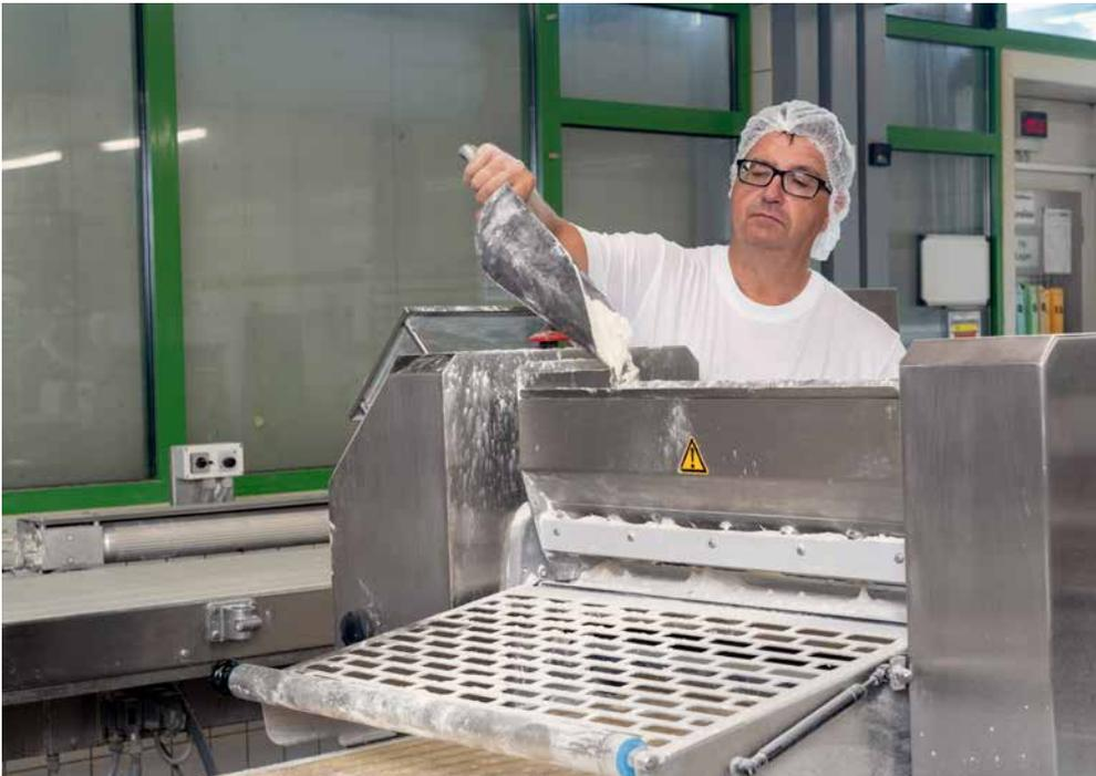
Abb. 21 Staubarme Mehlzugabe mittels Bäckerschaukel für die maschinelle Bemehlung
