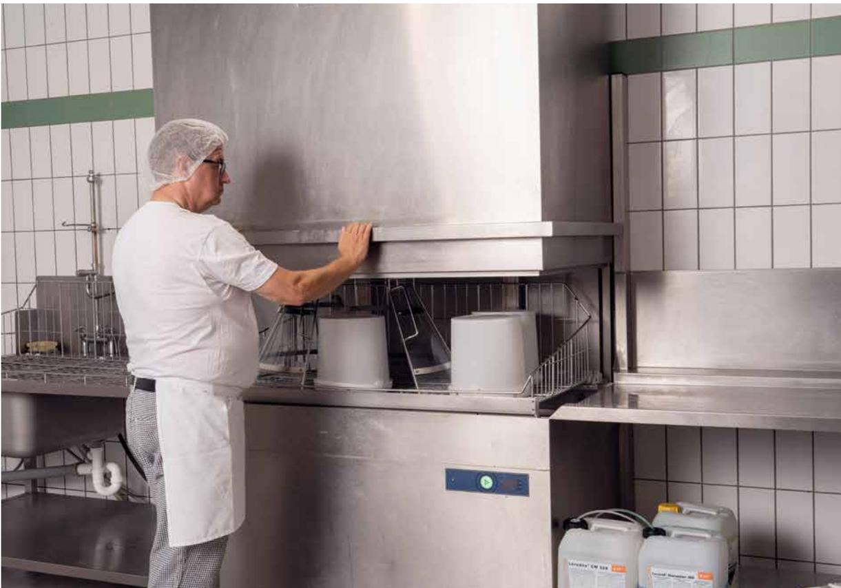
Abb. 34 Bedienung einer Haubenwaschmaschine
