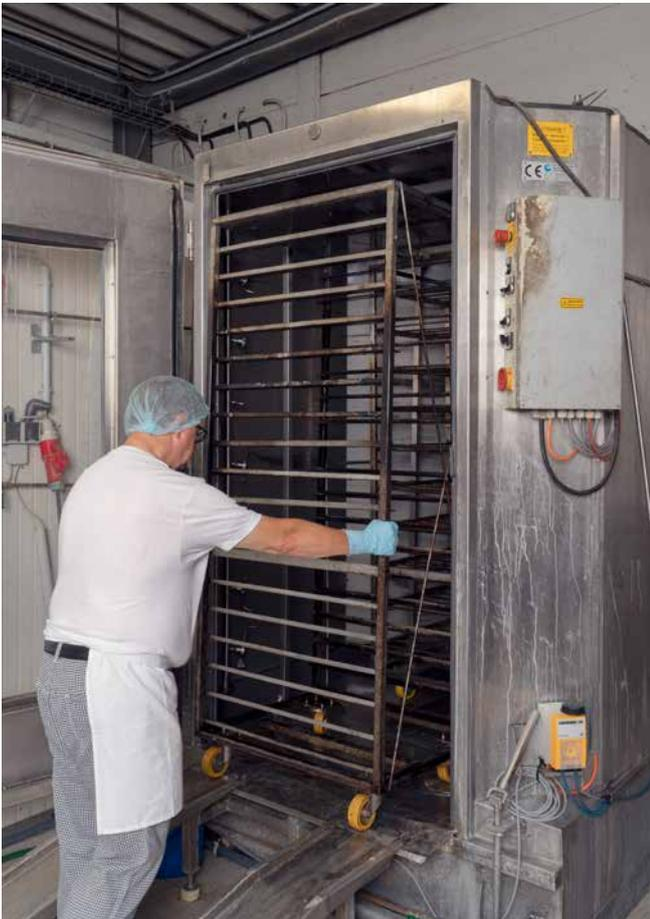
Abb. 35 Maschinelle Reinigung von Stikkenwagen
