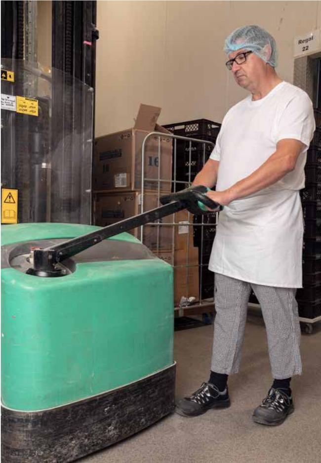
Abb. 10 Mitgänger-Flurförderzeug mit Fußschutzleiste
