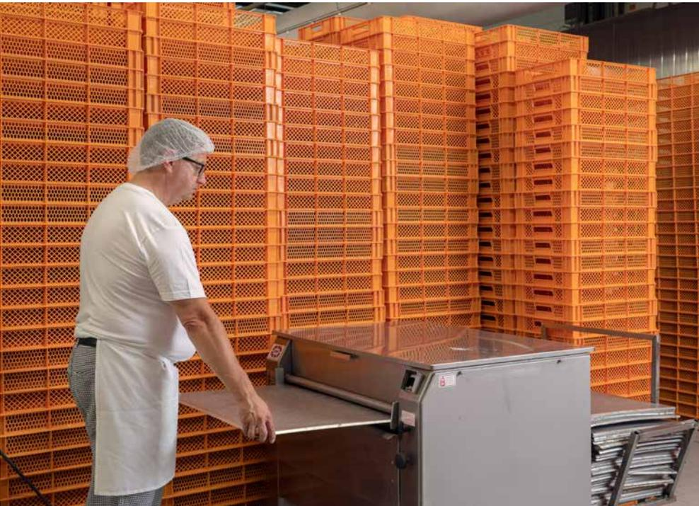
Abb. 36 Manuelle Bedienung einer Blechputzmaschine
