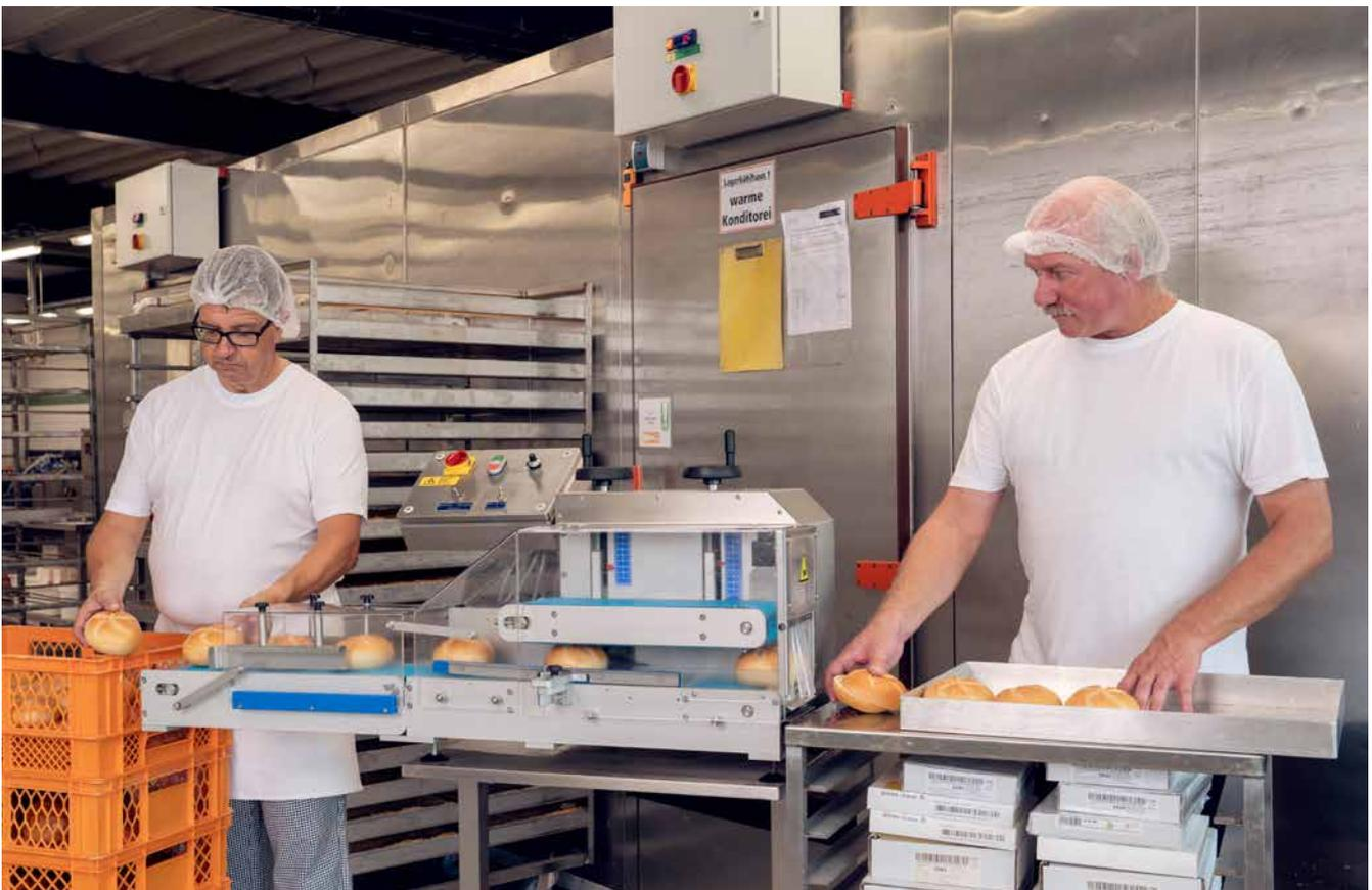
Abb. 31 Bedienung einer Brötchenschneidemaschine
