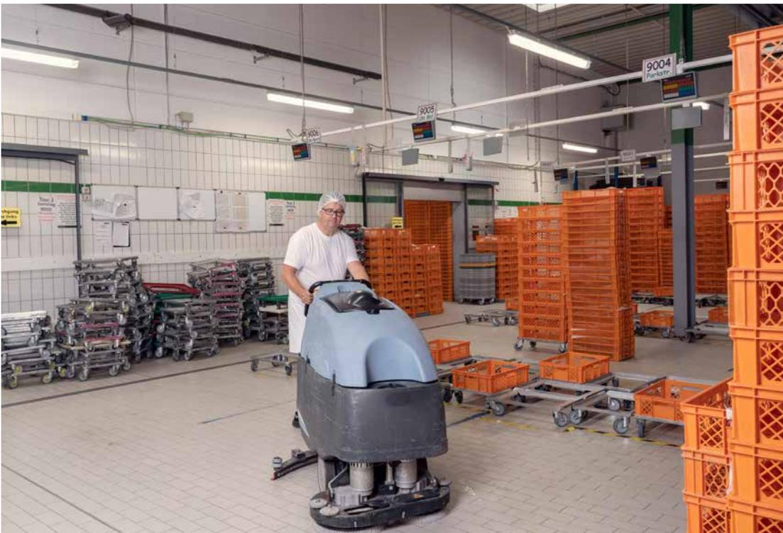
Abb. 37 Nassreinigung von Fußböden mit Reinigungsmaschine
