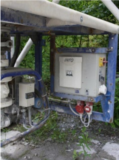
Abb. 5 Steereinheit mit Hauptschalter und Hinweisen zum sicheren Betrieb.
