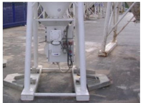
Abb. 4 Verbreiterung der Aufstandsflächen zur Erhöhung der Standsicherheit
