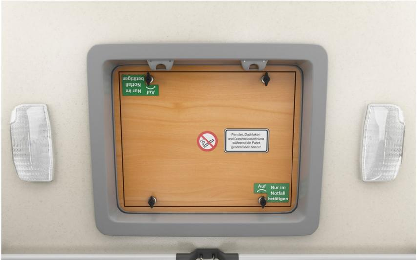
Abb. 3 Durchstiegsöffnung im Fahrerhaus – im Notfall, nach unten zu öffnen
