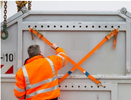
Abb. 35 Sicherung gestapelter Absetzbehälter durch X-Zurrung
