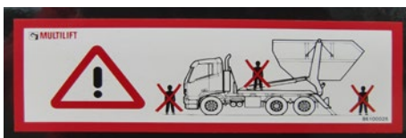
Abb. 27 Hinweis auf Gefahrenbereiche
