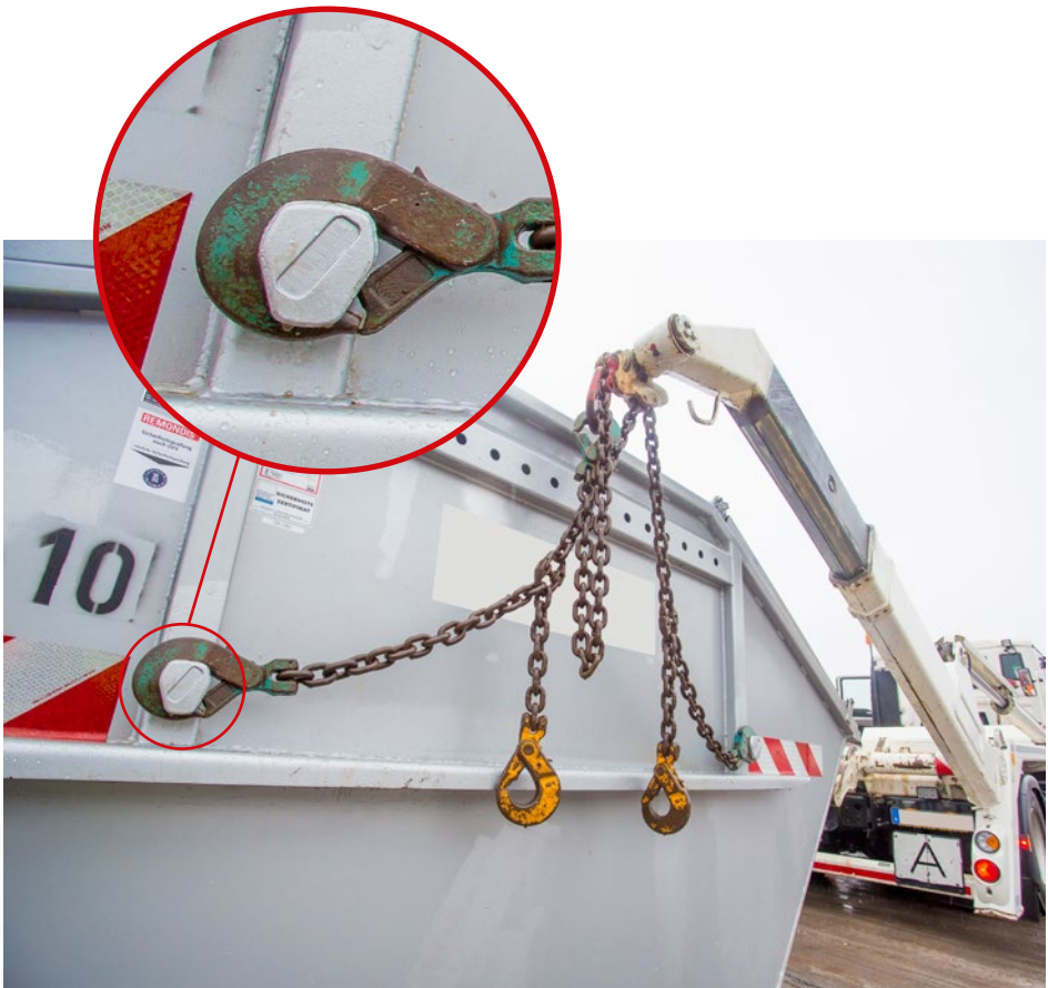
Abb. 9 Die Ketten mit ihren Haken müssen mit Sicherungen gegen unbeabsichtigtes Aushängen ausgerüstet sein
