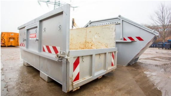
Abb. 21 Absetzbehälter mit halbhoher Klappe
