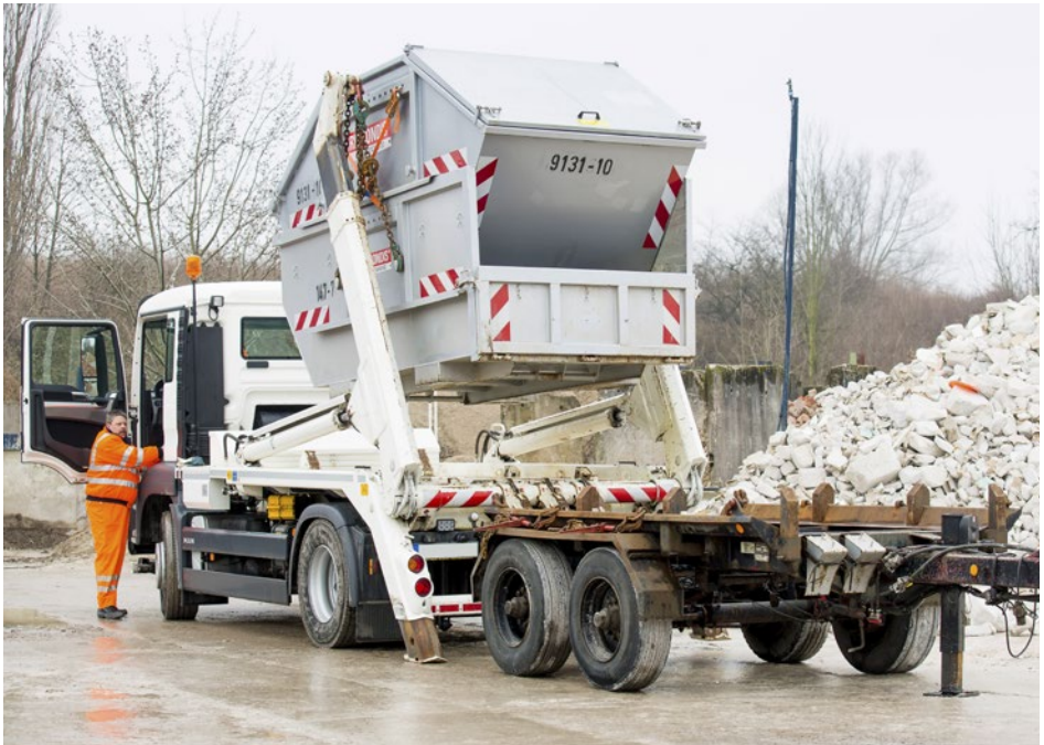
Abb. 5 Vom Bedienplatz aus können die Gefahrenbereiche eingesehen werden
