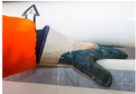
Abb. 24 Quetschstelle zwischen Zylinder und Rahmen
