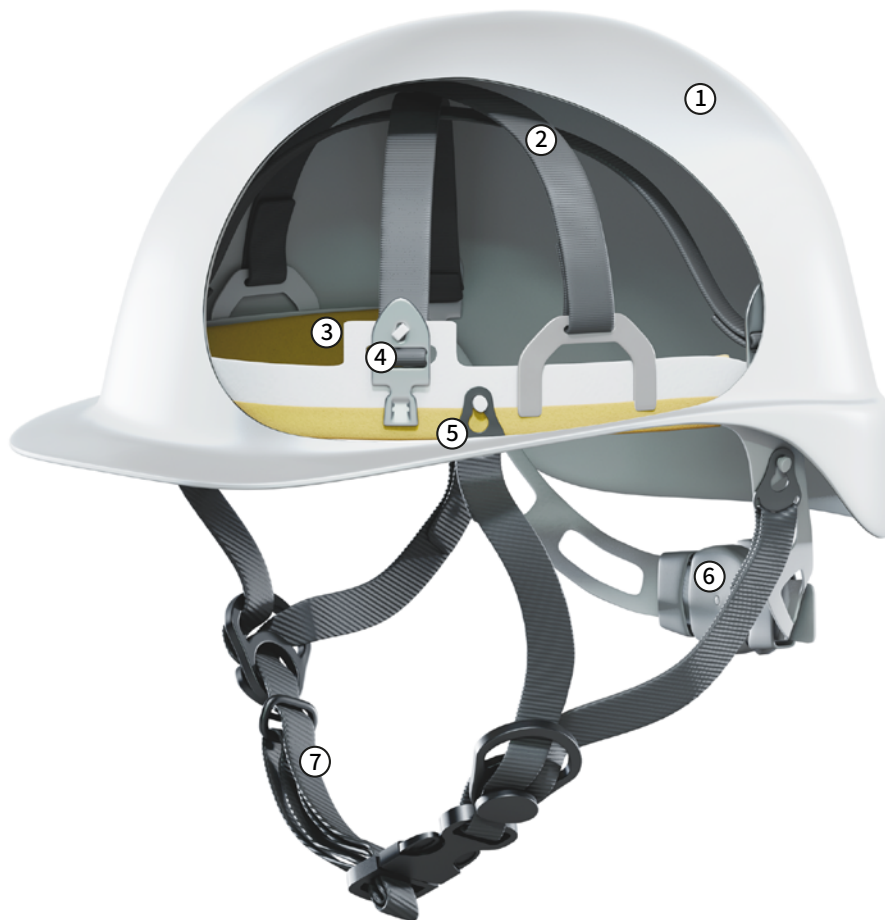
Abb. 11 Prinzipieller Aufbau einer Innenausstattung mit Stoßdämpfungsbändern
