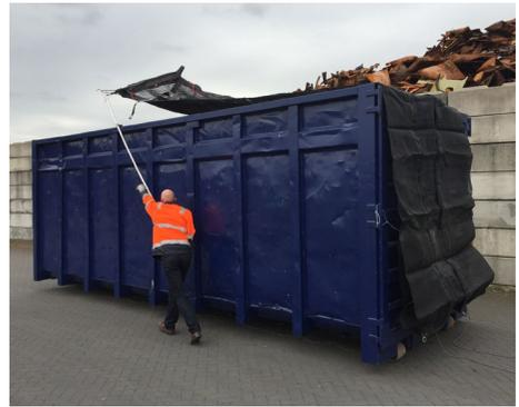
Abb. 37 Manuelles Abdecksystem mit einer Stange und Laufrad
