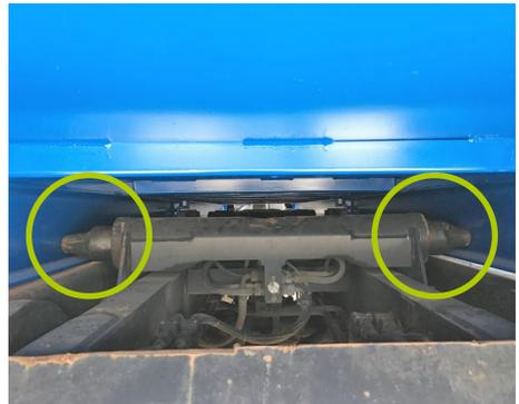
Abb. 16 Hydraulische Bolzenverriegelung
