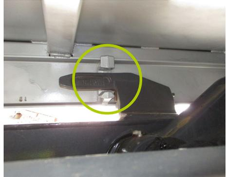
Abb. 14 Verriegelungsdorn und Verriegelungsöse
