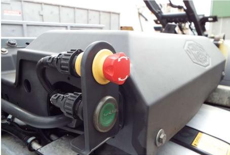
Abb. 5 Not-Halt-Taster am Bedienplatz
