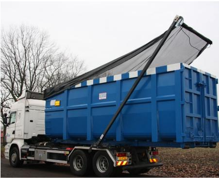
Abb. 36 Hydraulisches Abdecksystem
