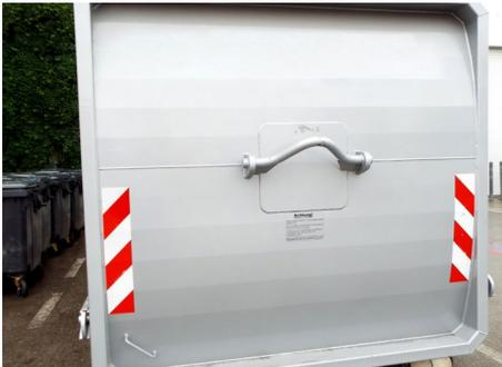
Abb. 24 Rangierbügel an der Tür der mobilen Behälterpresse
