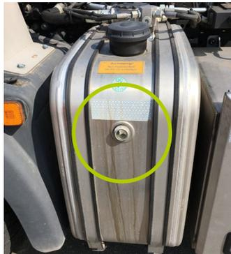
Abb. 10 Hydraulikanlage mit Füllstandanzeige
