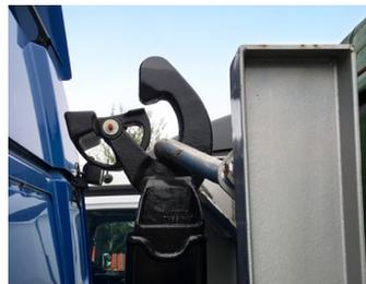
Abb. 8 Aufnahmehaken mit Schwerkraftsicherung
