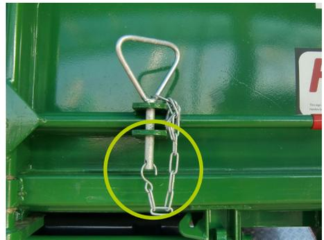
**Abb. 29** Gesicherter Verschluss am Abrollbehälter
