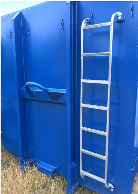
Abb. 30 Sicher begehbarer Aufstieg am Behälter
