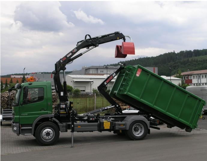
Abb. 18 Abrollkipper mit Lkw-Ladekran
