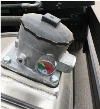
Abb. 9 Filter mit Verschmutzungsanzeige
