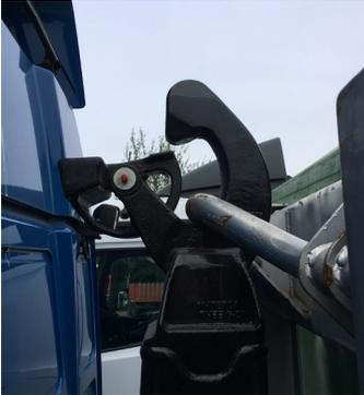
Abb. 13 Aufnahmehaken und Aufnahmebügel
