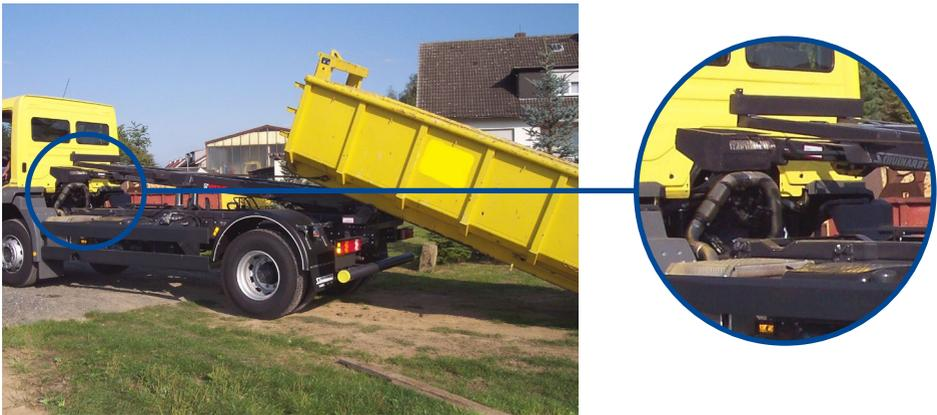
Abb. 19 Kipprahmen mit Seilwinde
