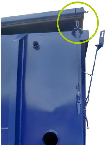
Deckel müssen gegen unbeabsichtigtes Öffnen gesichert werden können! (Abb. 27)
