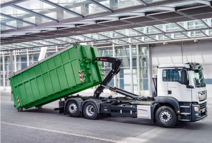
Abb. 1 Abrollkipper, Behälteraufnahme
