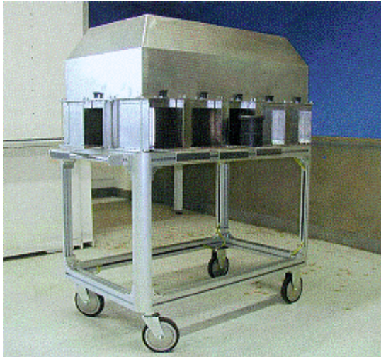
Abb. 29 "Geschützter" Abstellwagen für Treibsätze mit Brandschutzhaube
