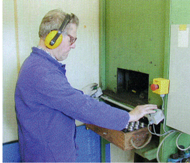
Abb. 26: Bedienung einer Presse – Sicherung der Durchreichöffnung mittels Zweihandschaltung
