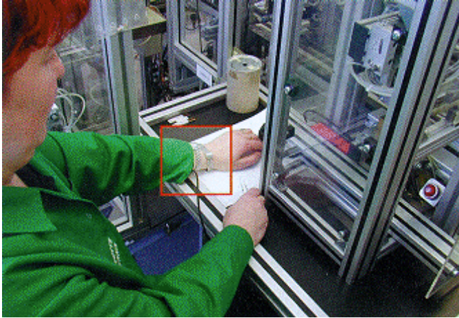
Abb. 15: Persönliche Erdungsmaßnahmen ("Armband") gegen elektrostatische Aufladung
