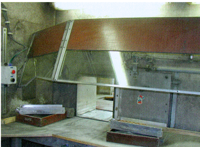
Abb. 16: Beispielhafter Arbeitsplatz mit ortsfestem Gesichtsschutz (Gefährdung durch Flammen)
