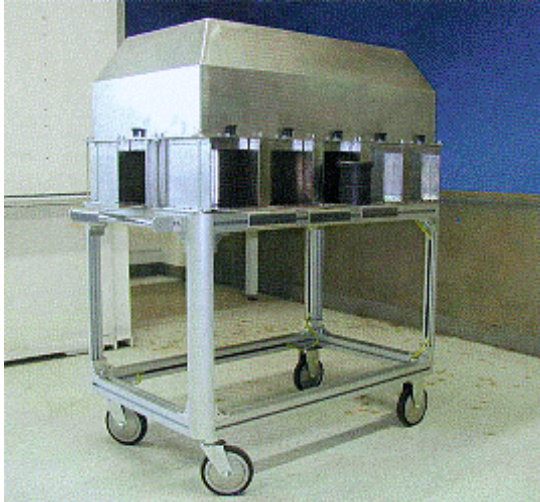
Abb. 29 "Geschützter" Abstellwagen für Treibsätze mit Brandschutzhaube
