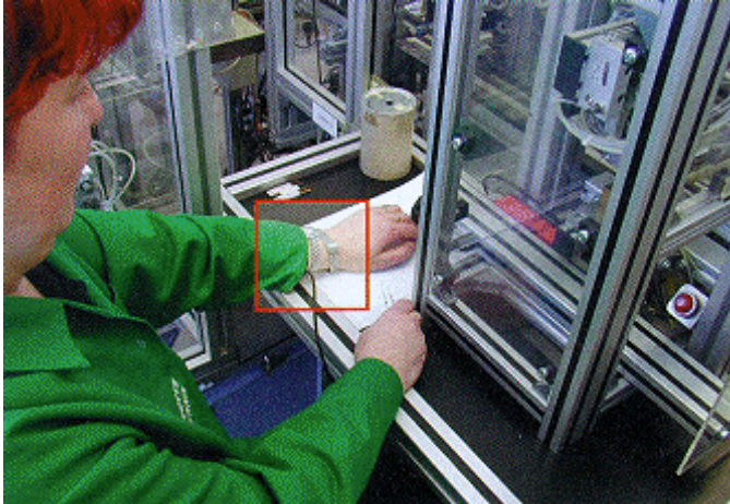
Abb. 15: Persönliche Erdungsmaßnahmen ("Armband") gegen elektrostatische Aufladung
