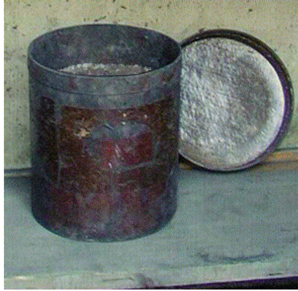
Abb. 8: Beispiel für Gefahrgruppe 1.1.2 (Anfeuerungssatz in 10 kg-Trommel)
