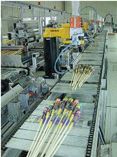
Abb. 28: Taktstraße zum Verpacken von Silvesterraketen
