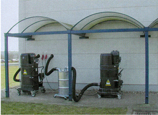
Abb. 17: Ortsfeste Staubsauganlage in der Airbag-Treibsatzfertigung
