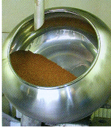
Abb. 6: Beispiel für Gefahrgruppe 1.4 (Dragieren mit Wasser)
