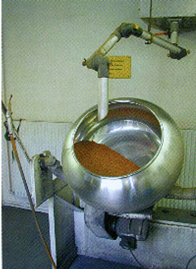
Abb. 25: Dragieren eines Sternsatzes
