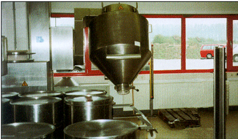
Abbildung 27: Mit Lichtschranke gesicherter Taumelmischer (Nachlauf muss so gering sein, dass Mischer steht, bevor Person ihn erreichen kann)
