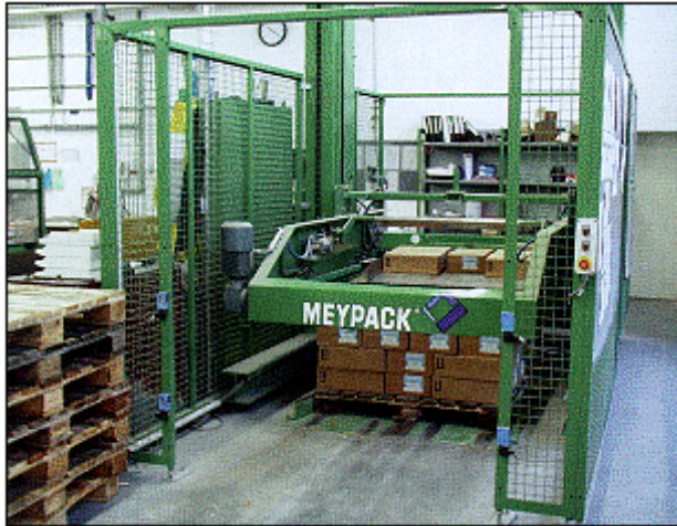
Abbildung 30: Durch Lichtschanke gesicherter Palettierer
