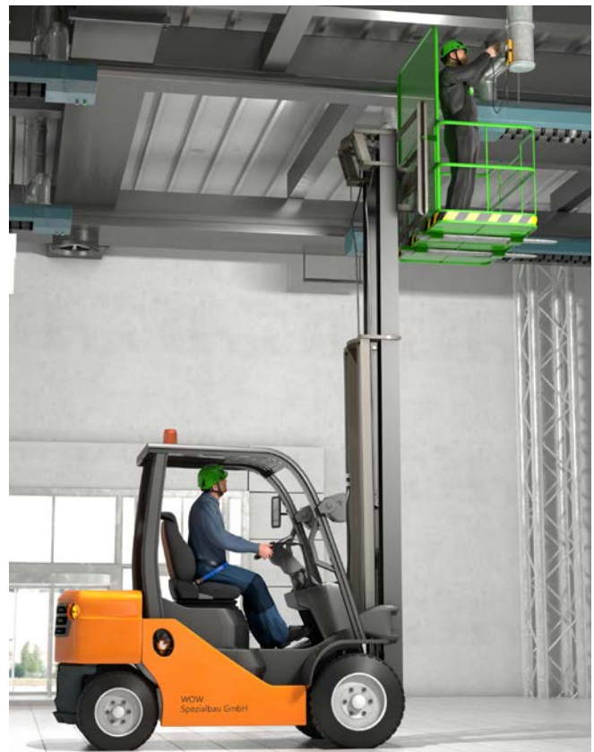
Abb. 2 Flurförderzeug mit Arbeitsbühne
