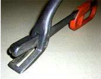
**Abbildung 10: Schneidvorrichtung mit Bandendenhalter**
