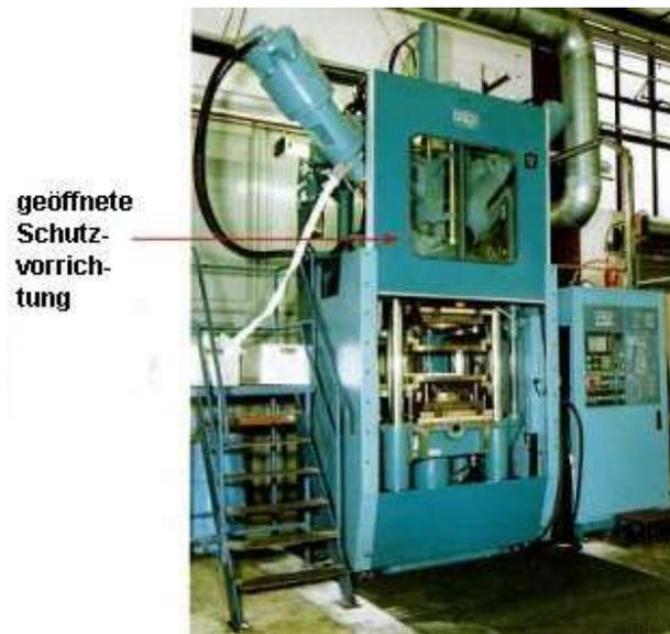
Abbildung 34: Spritzgießmaschine
