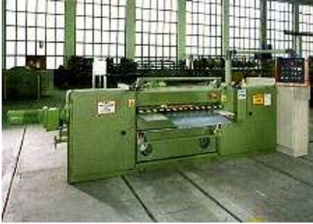
**Abbildung 27: Bandmesser-Spaltmaschine zum Schneiden fertiger Produkte**
