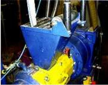
**Abbildung 25: Beschickungsöffnung am Extruder**
