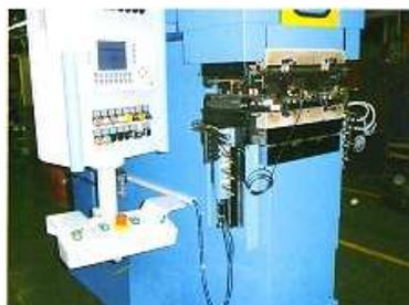
Abbildung 35: Zweihandsteuerung an einer Spritzgießmaschine
