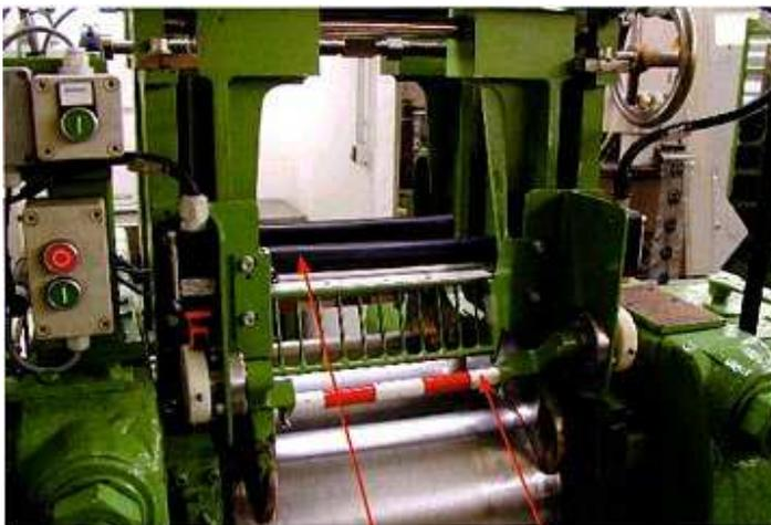
Abbildung 21: Sicherung von kleinen Walzwerken (Durchmesser < 400 mm)
