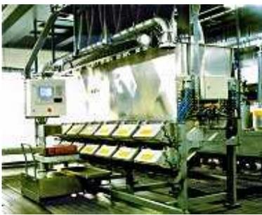
**Abbildung 11: Anlage zum Abwiegen von Einsatzstoffen**
