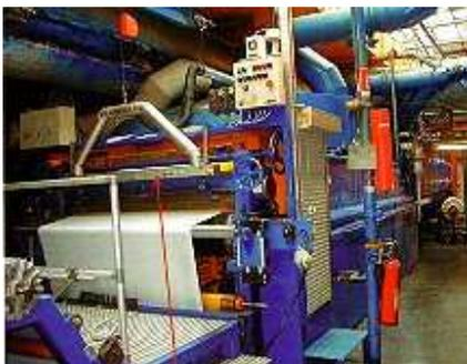
**Abbildung 28: Streichanlage mit lokaler Absaugung**
