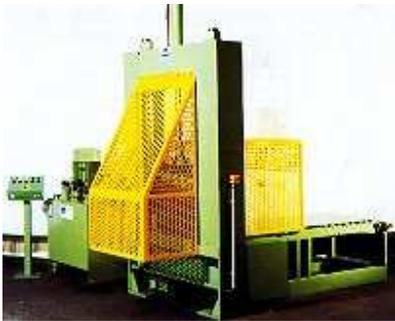
Abbildung 8: Kautschukspalter (Werkfoto) mit trennenden Schutzeinrichtungen
