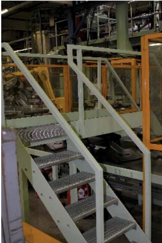
Abbildung 2: Sicherer Übergang über ein Förderband
