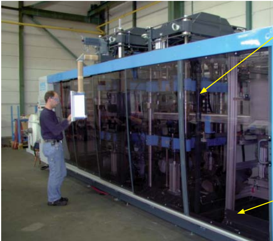
Abbildung 8: Warmformmaschine mit verriegelten trennenden Schutzeinrichtungen und hintertretbaren Bereichen
