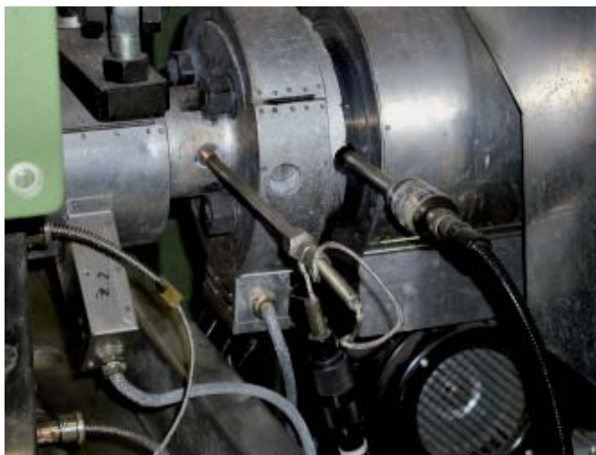
Abbildung 26: Druckabsicherung durch Druckaufnehmer
