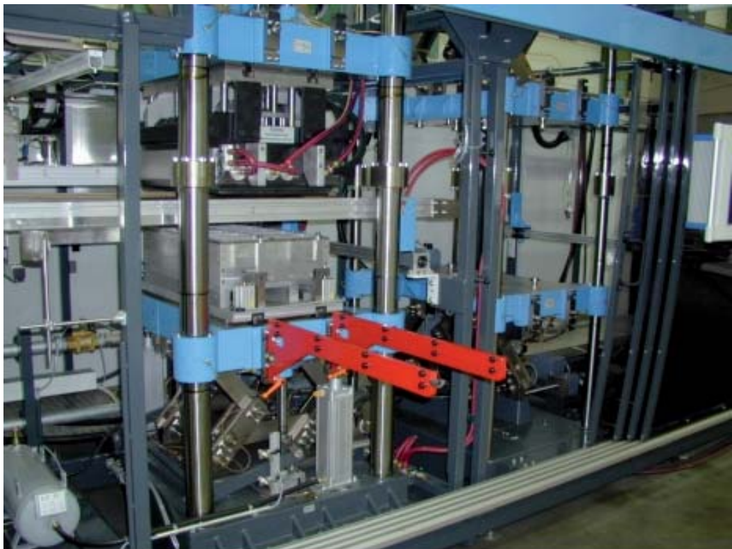
Abbildung 5: Hilfseinrichtung zum Ausbau eines Werkzeugs an einer Warmformmaschine
