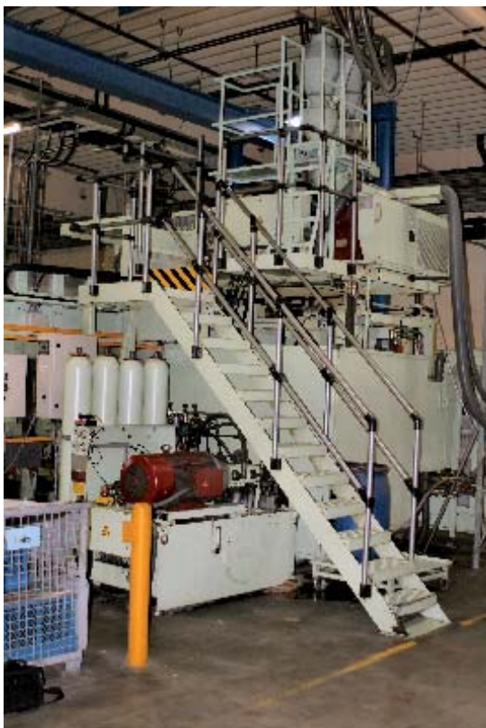
Abbildung 2: Sicherer Übergang über ein Förderband
