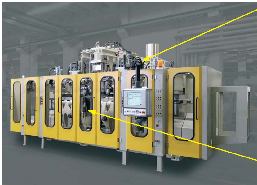
Abbildung 10: Blasformmaschine mit verriegelten trennenden Schutzeinrichtungen
