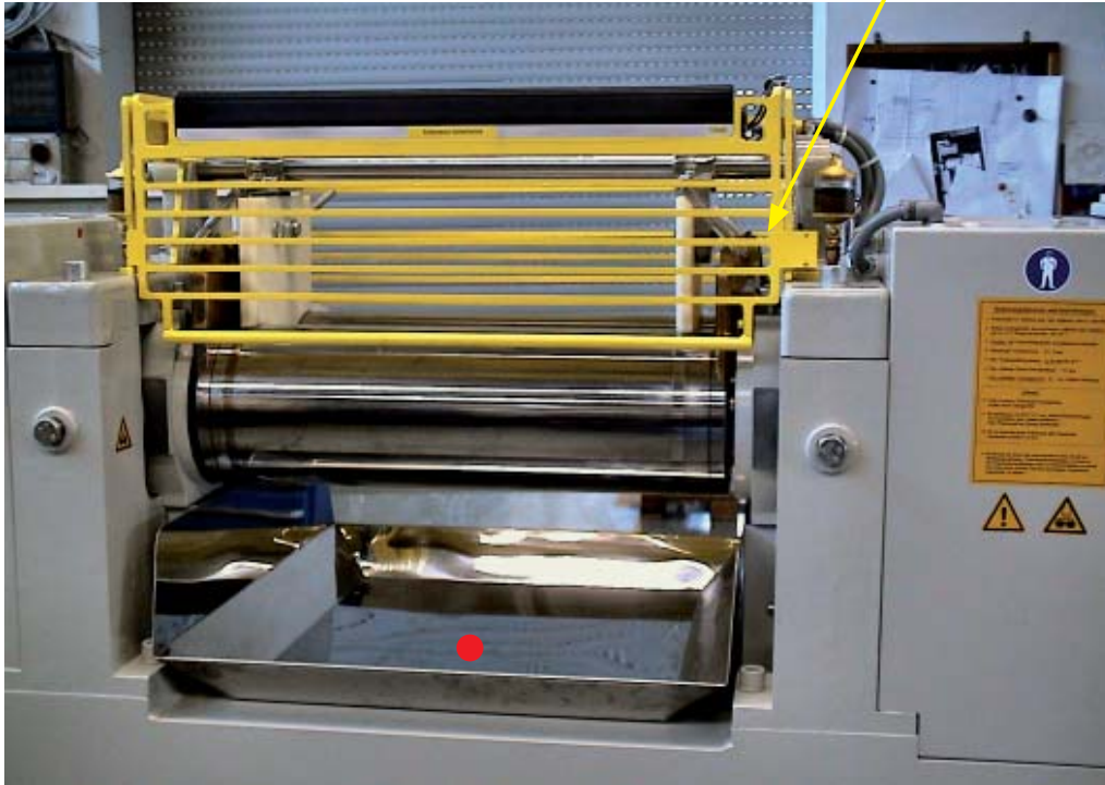
Abbildung 20: Walzwerk mit mechanischen Schutzeinrichtungen mit Annäherungsreaktion
