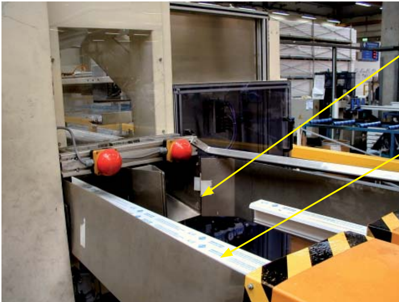
Abbildung 17: Quetsch- und Scherstellen hervorgerufen durch die Transportbewegung des Profils
