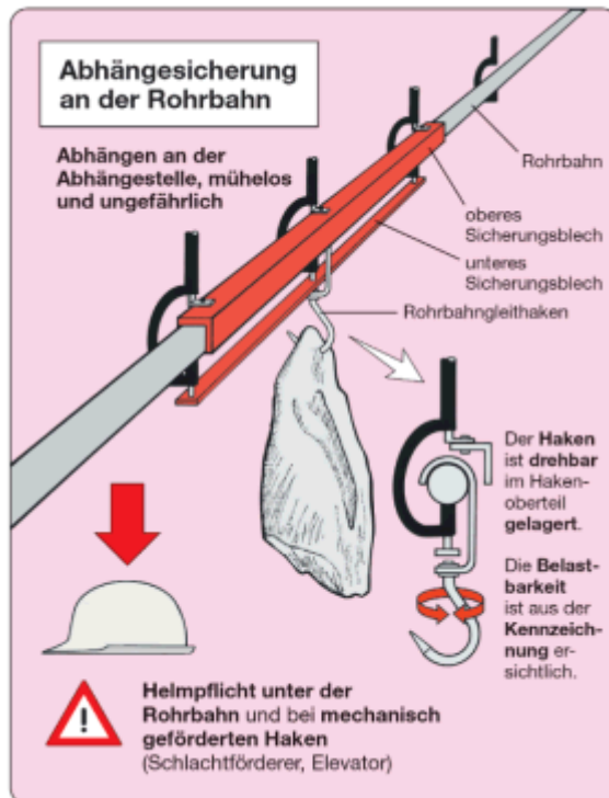
Bild 14: Abhängsicherungen an der Rohrbahn
