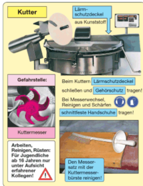
Bild 43: Schutzmaßnahmen am Kuttter
