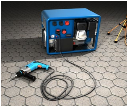
Abb. 2 Einzelnes Betriebsmittel, direkt am Stromerzeuger angeschlossen
