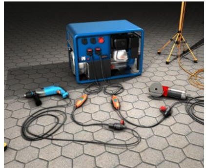
Abb. 3 Betrieb sämtlicher Betriebsmittel über jeweils eine PRCD
