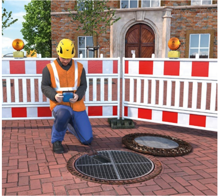
Abb. 14 Überprüfen der Schachtatmosphäre
