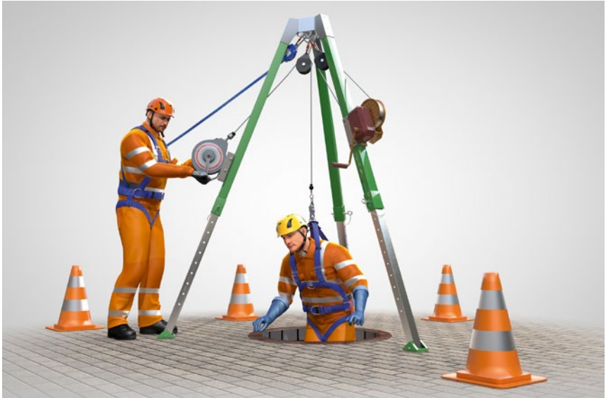
Abb. 15 Dreibein mit Rettungshubgerät und Auffanggurt
