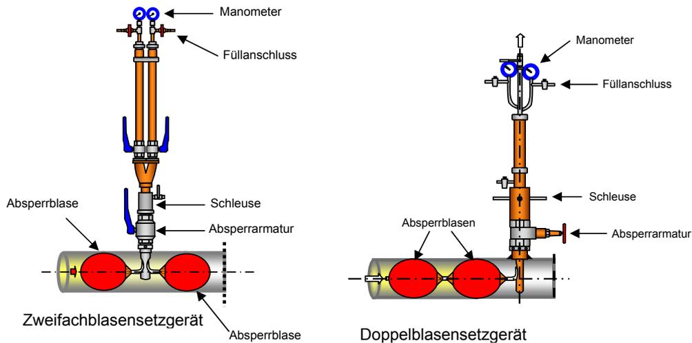
Ab einem Betriebsdruck von 30 mbar oder Leitungsdurchmesser von DN 150 (vgl. auch DVGW-Arbeitsblatt G 465-2) sind zwei Absperrblasen mit zwischenliegender Entlüftung einzusetzen. Eine Druckentspannung des Zwischenraums ist sicherzustellen. Vorzugsweise sind zertifizierte Absperrblasen und Blasensetzgeräte zu verwenden (siehe DVGW VP 620-1, VP 621-1 und VP 621-2).
