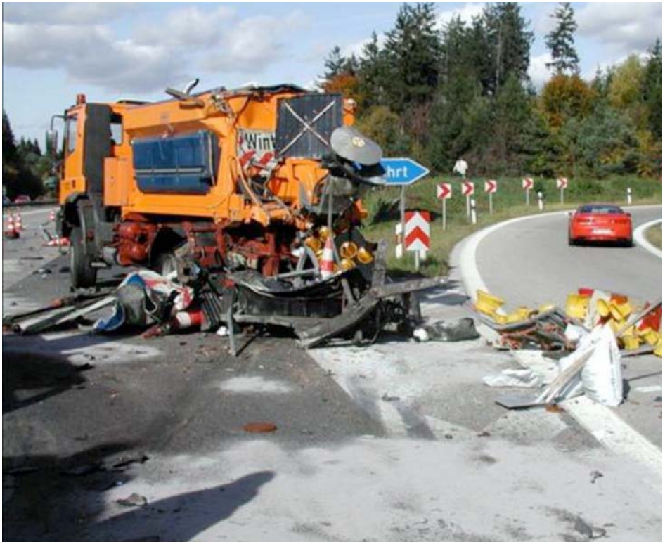
Abb. 7 Sicherungsfahrzeug nach LKW-Aufprall
